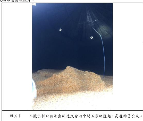
約 3M + 薨 吳者十 90cm\*68cm 约 2.5M + 约 2M + 103cm 因穀倉無法正常出料,罹災者爬過小山丘走到仍在出料第三個出 料口後,站在玉米堆上方隨著玉米粒往下沉形成流砂現象,造成
