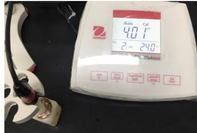
圖 18 標準液校正(pH 4.0)
