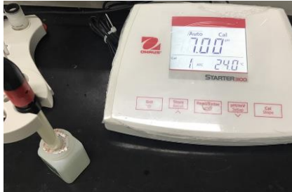
圖 17 標準液校正(pH 7.0)
