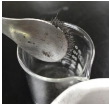
圖 16 打磨區鋼粉照片
