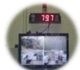
作業區噪音直讀 (於82-85dBA噪音區裝設)
