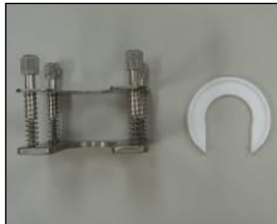
加裝鐵氟龍墊片
