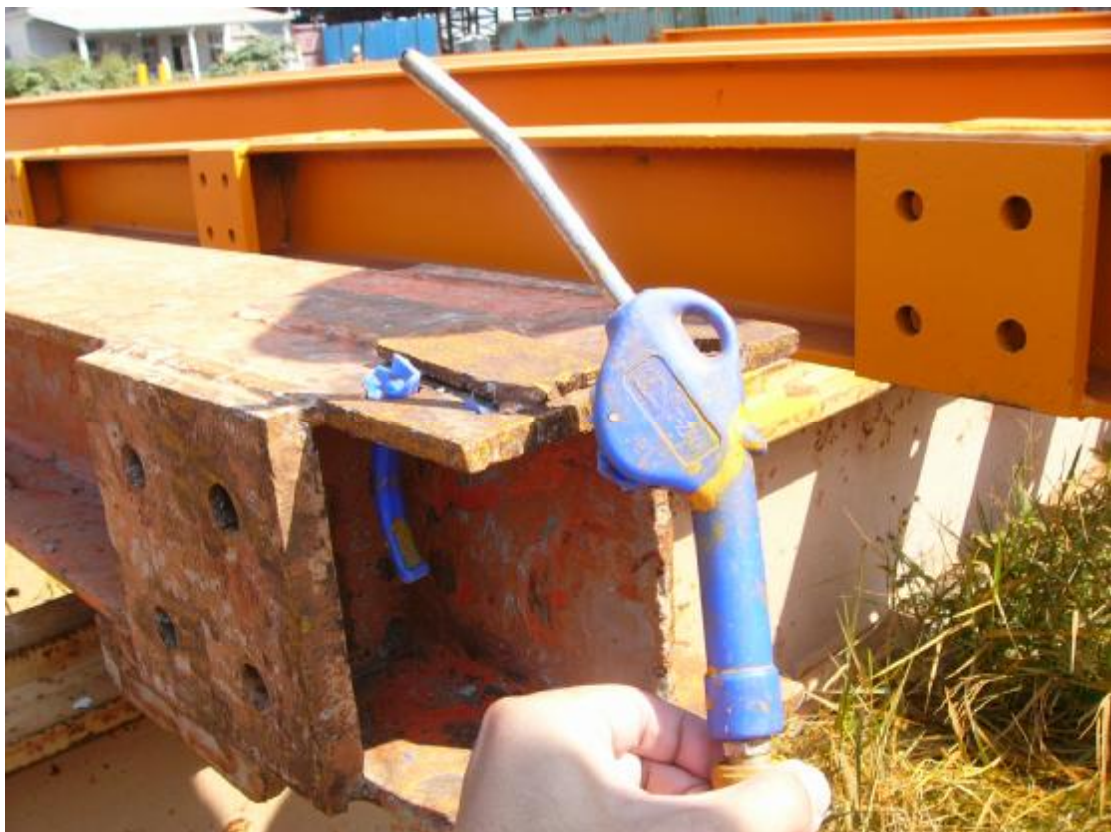
照片 2 空壓槍塑膠扳機斷裂在構件開孔處
