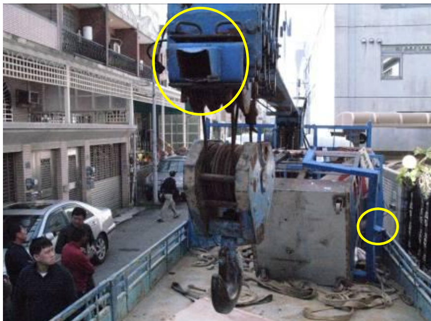
說明 吊籃由支桿中間焊接處撕斷裂。(照片由警方提供)
