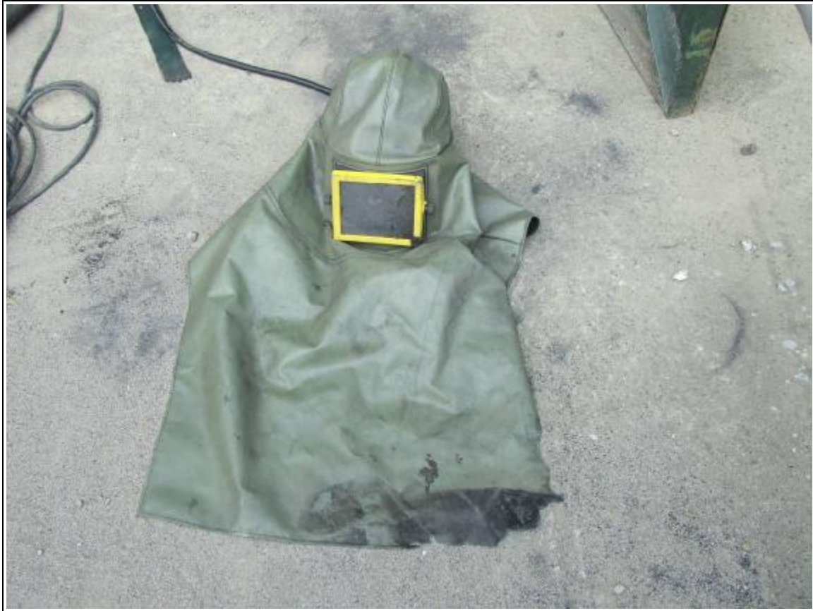
照片七 黃○○工作時配戴噴砂頭罩，腰部左側處有明顯遭噴砂槍破壞痕跡。
