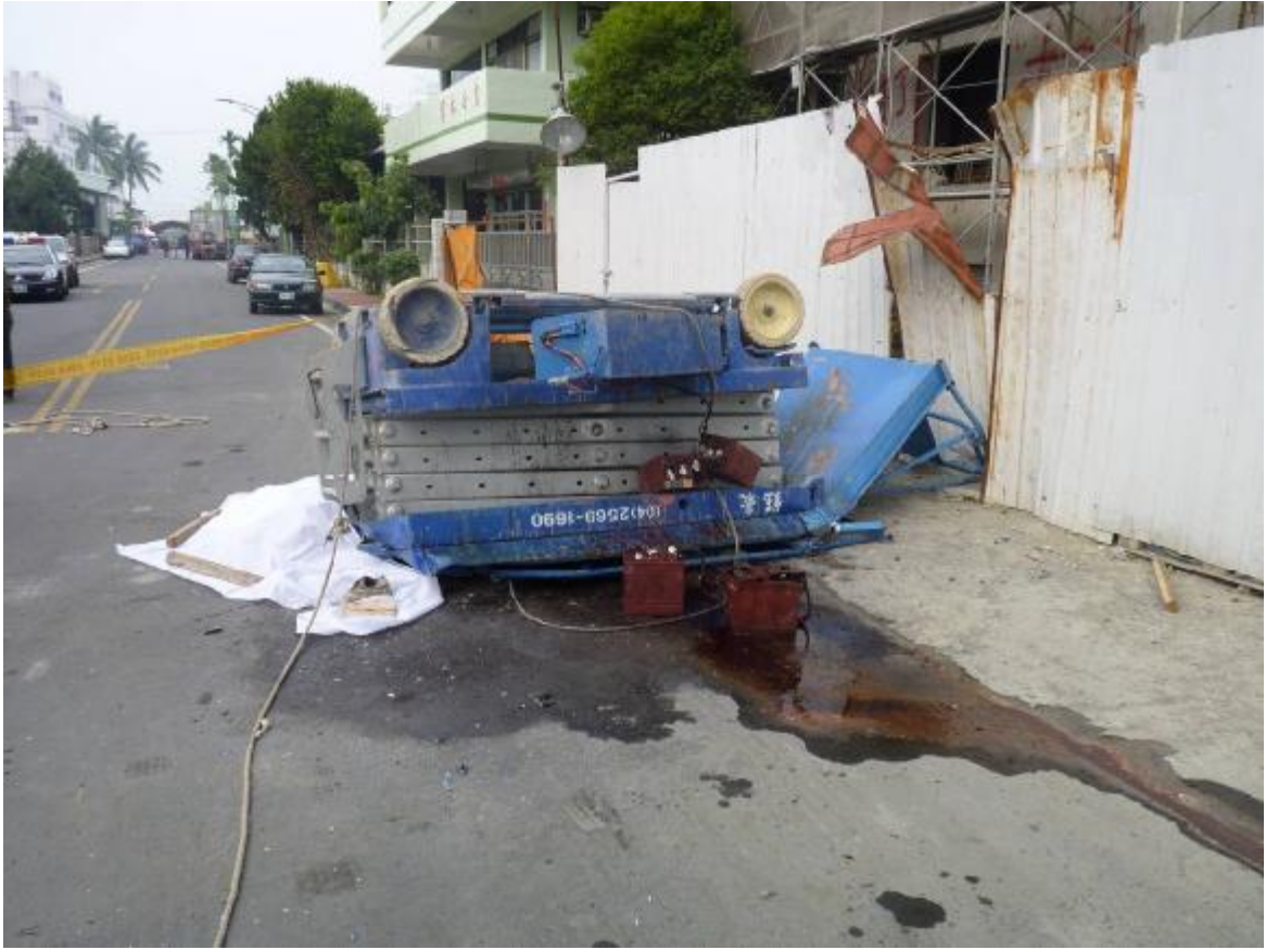
照片 2 罹災者及高空工作車墜落地面後情形
