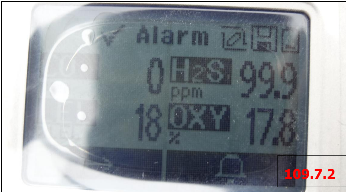
說明 照片 7：廠區內肇災下水道人孔內部使用四用氣體偵測器測定肇災之下水道人孔內部空氣中一氧化碳濃度為 0 ppm、硫化氫濃度為 99.9 ppm、氧氣濃度為 17.8%、另可燃性氣體測得濃度為為爆炸下限之 18%。）
