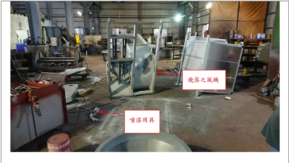
照片3 罹災者從事噴漆作業之風機及使用之噴漆用具(風機因救災關係已翻轉90度)。
