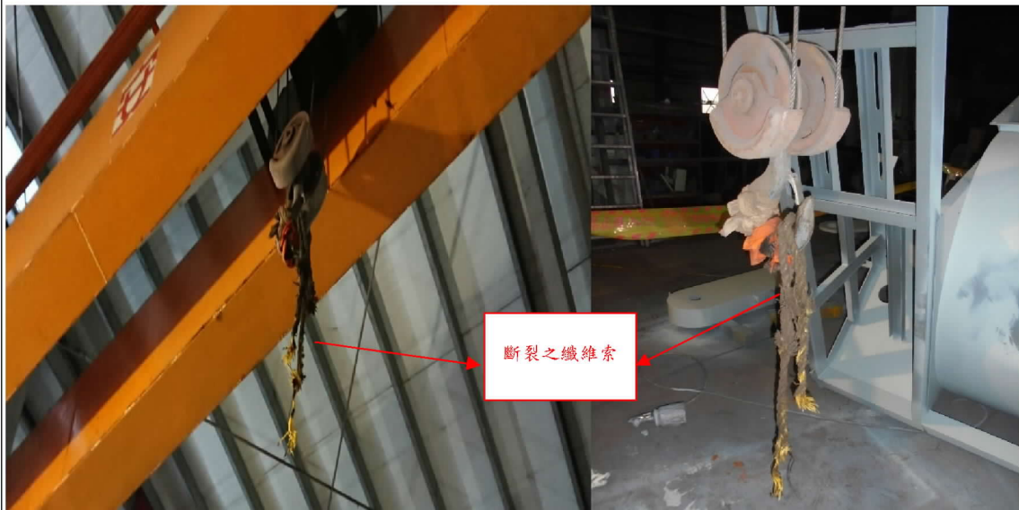
照片 2 災害現場照片，斷裂後之纖維索鈎掛於固定式起重機吊鈎上。
