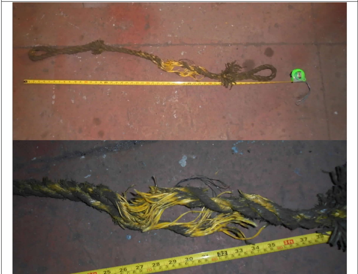
照片4 災害發生時吊掛作業使用之吊索(纖維索)，長度約120公分。
