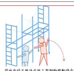
因地面碎石塊造成施工架腳輪移動時卡住,人 員拉力與腳輪卡住形成之支點產生傾覆力矩 超過施工架自身重力矩,致該整架施工架向靠 窗區樓板邊緣開口倒塌。
