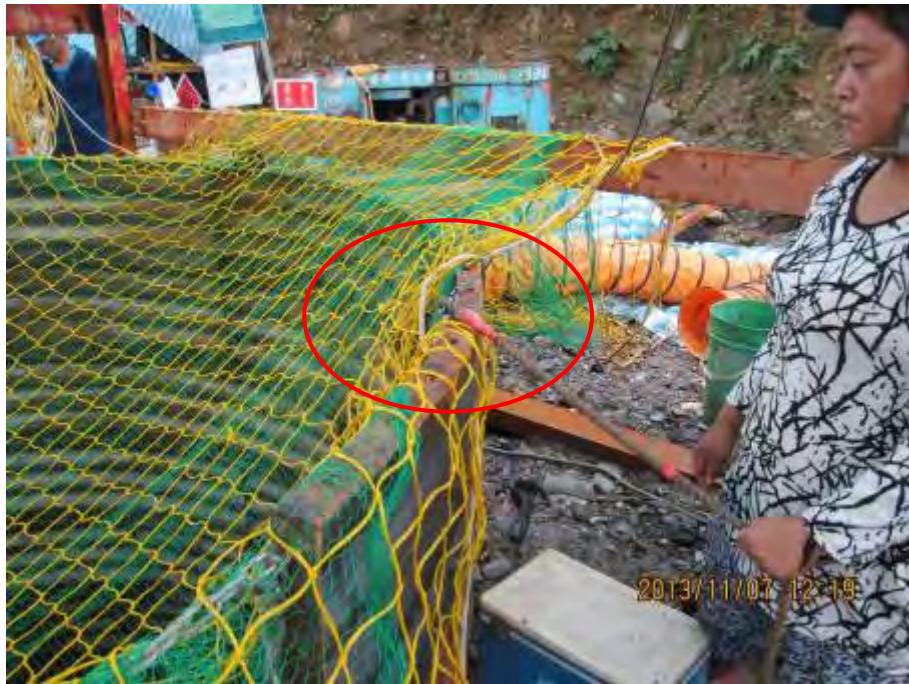
說明四 模擬安全帶勾掛在護欄之情形
