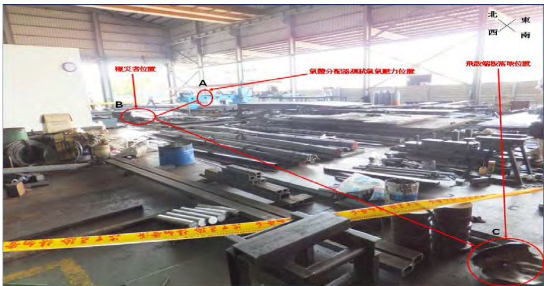
照片 2 肇災現場氣體分配器、罹災者與端板飛射路徑(示意圖)。
