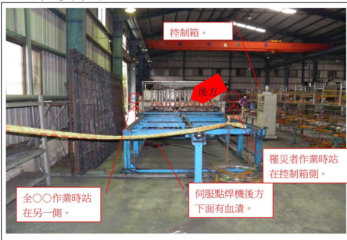
說明：罹災者作業時站在控制箱側，全○○作業時站在控制箱另一側示意圖。
