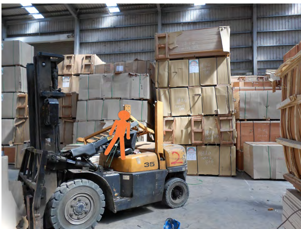
照片 2 堆高機頂蓬受壓損毀，罹災者作業位置(示意圖)。
