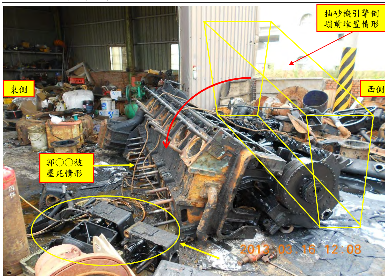
附照 1 說明：6.8 噸抽砂機引擎倒塌壓死郭○○之災害現場情形(警方提供)
