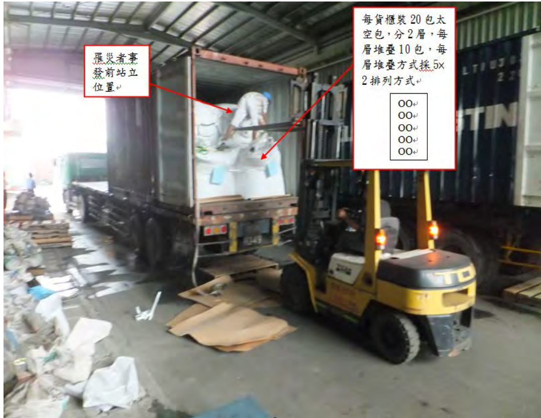
照片：貨櫃中裝進口米太空包堆疊方式、罹災者事發前站立位置。
