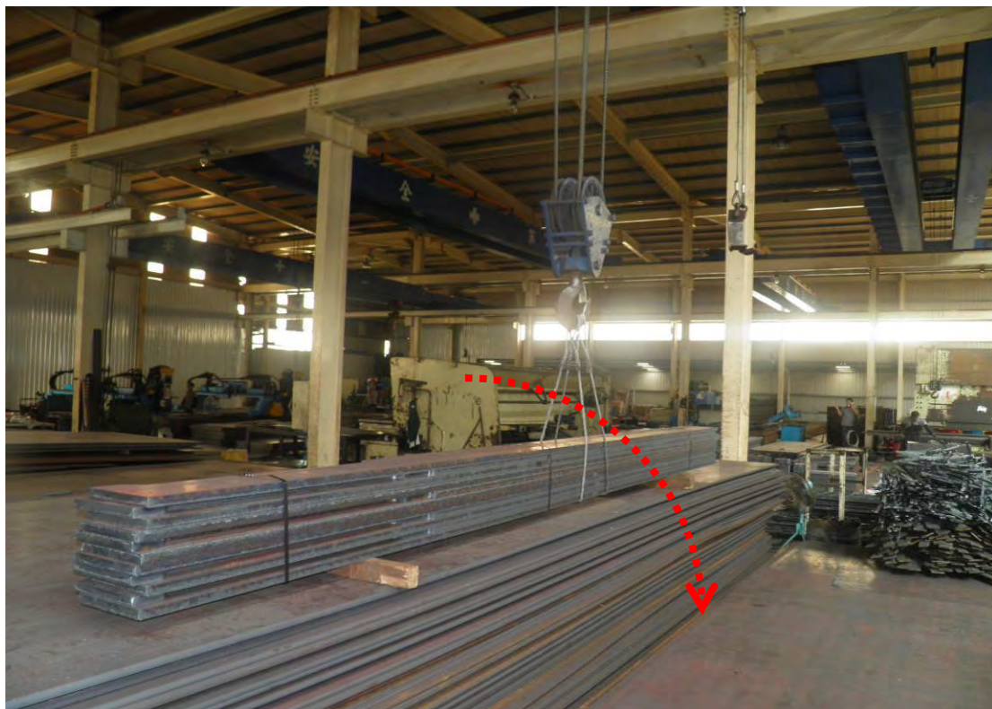
照片 1：重約 3.5 公噸之鐵板成品(災害後現場模擬)
