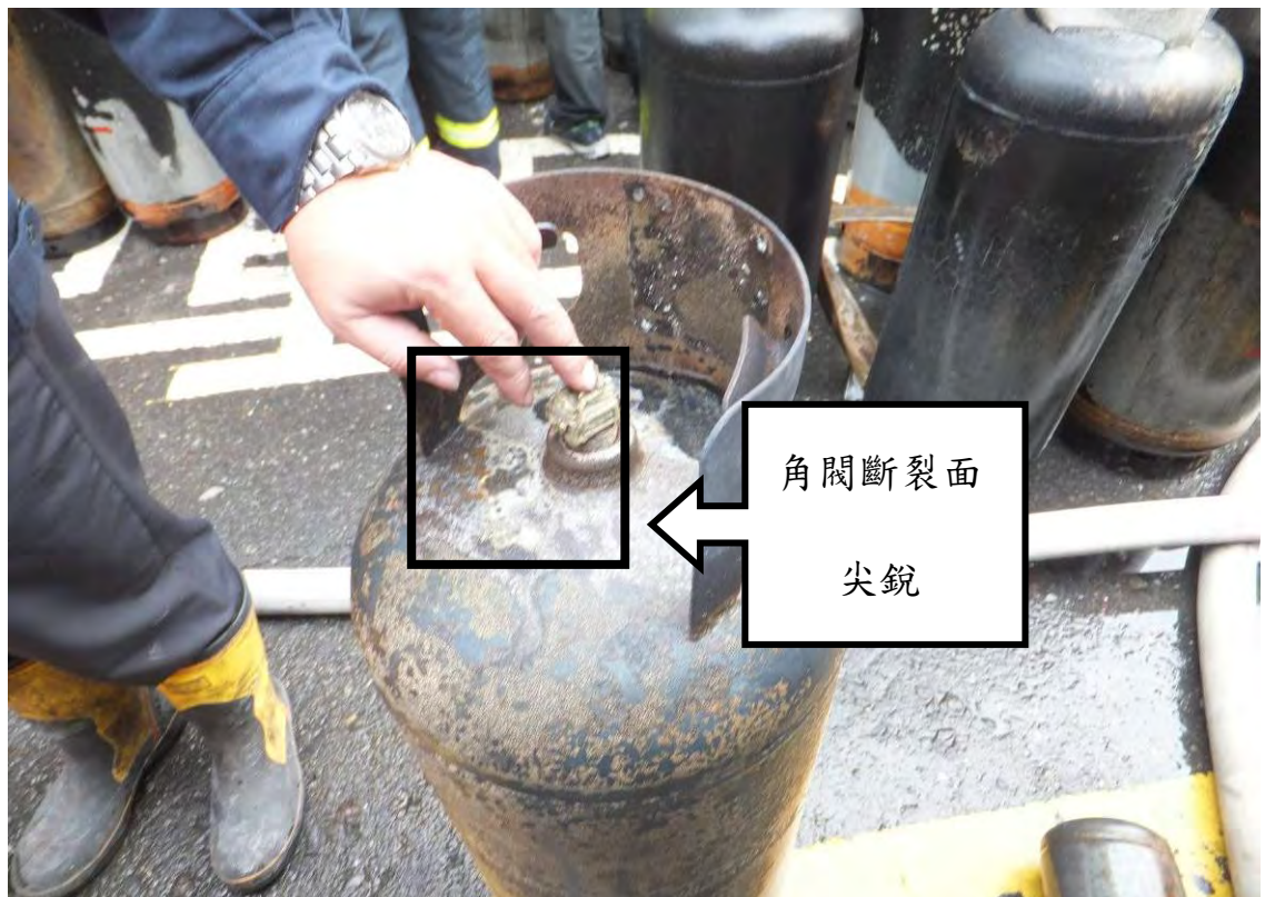
說明 3 疑似撞擊斷裂之鋼瓶閥
