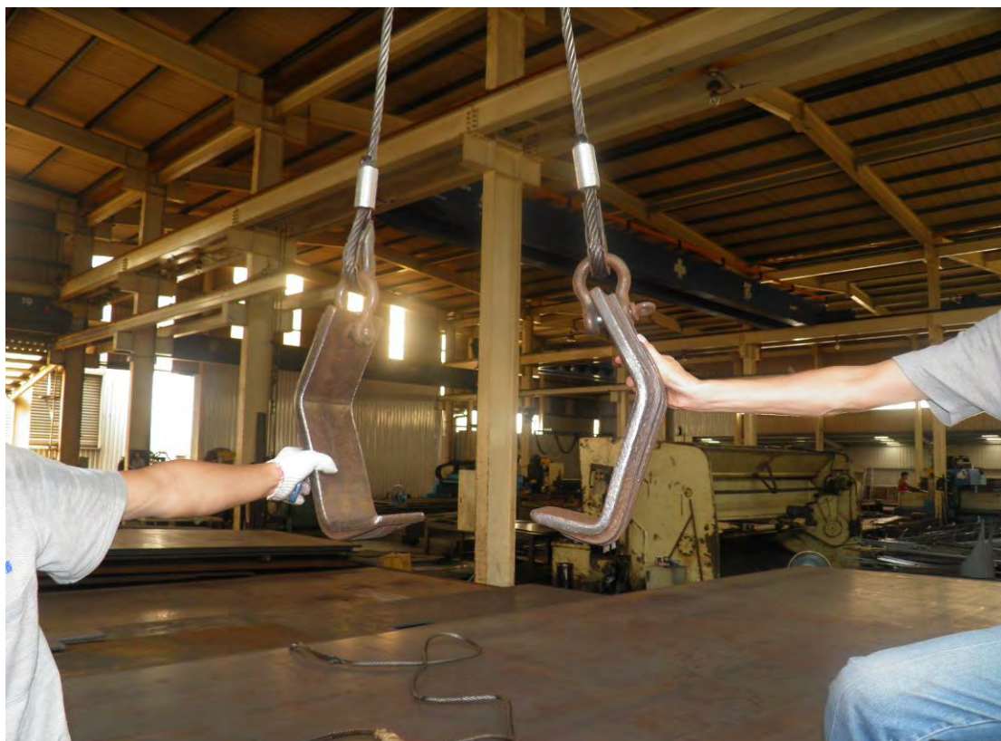
照片 2：罹災者使用之 L 型吊具
