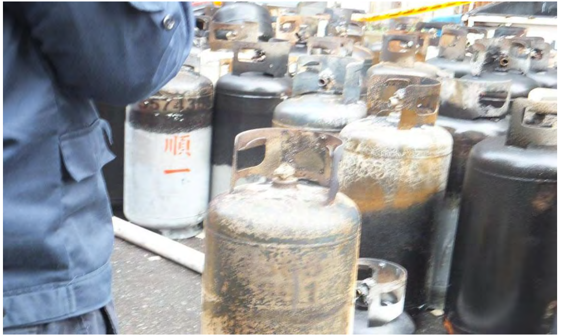
說明 2 疑似撞擊斷裂之鋼瓶閥
