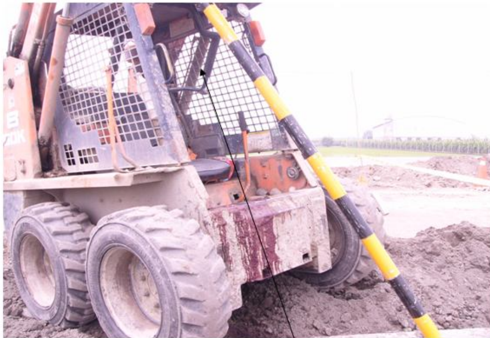
鏟土機為○○牌○○○○型，連動鎖定裝置失效，致座位保險桿未定位、仍能操作鏟土機鏟斗升降、傾卸作業。
