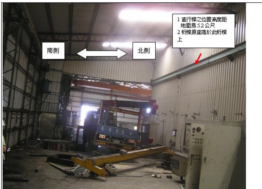
說明一 罹災現場桁樑及直行樑等相關位置之照片
