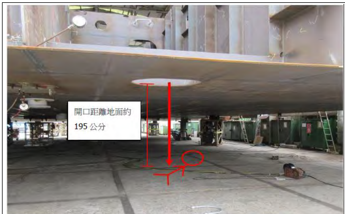
說明二 罹災者自高度 195cm 船段平面上之開口（800mm*600mm 橢圓型）墜落地面模擬圖。
