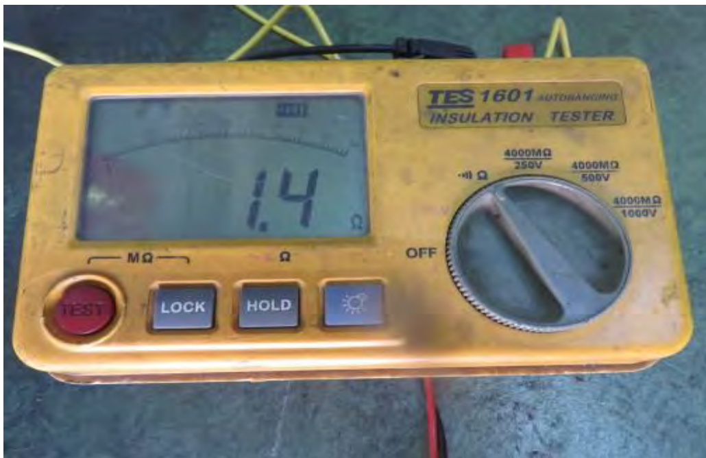
說明八 量測鐵架對地之接地電阻為 1.4Ω。
