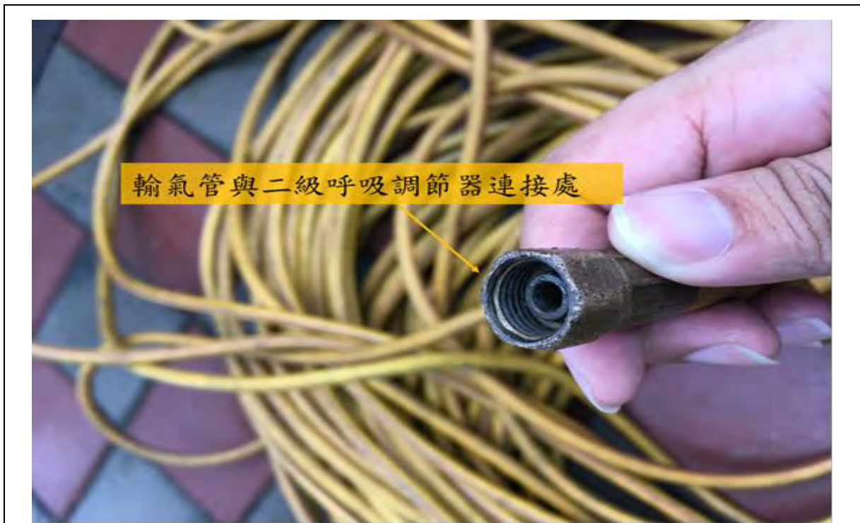
說明四 輸氣管與潛水人員之二級呼吸調節器接合方式為螺紋鎖附，且未發現輸氣管連接處螺紋有滑牙等損壞情形。
