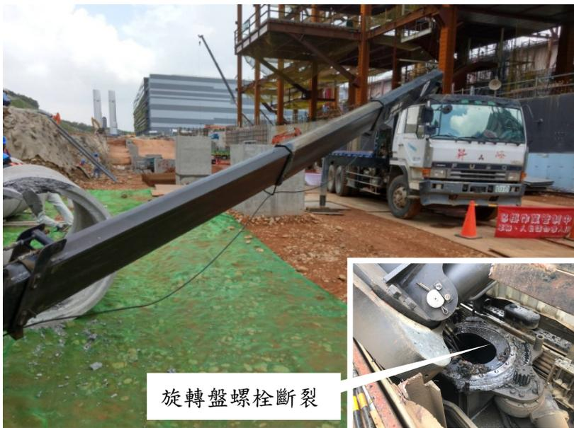
照片說明：移動式起重機旋轉盤螺栓斷裂，吊臂傾倒
