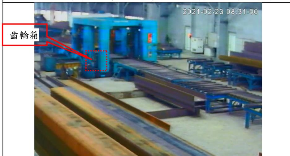
8 時 31 分肇災齒輪箱伺服馬達之制動器（剎車器）故障未能維持
