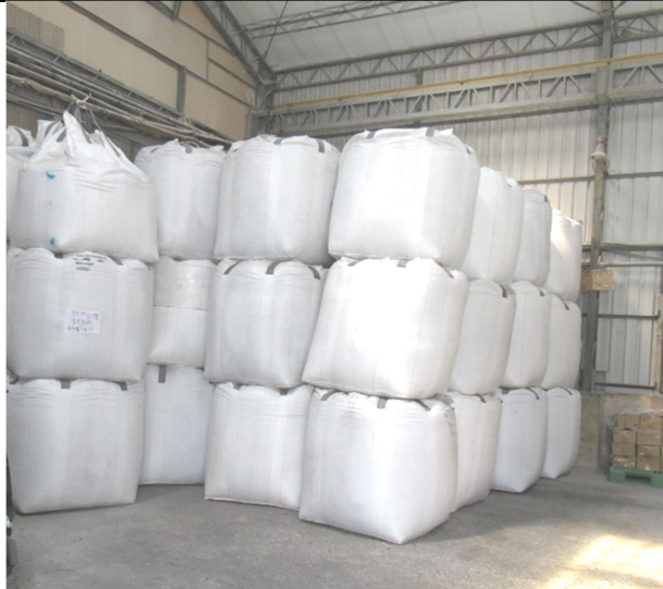
不正確堆置方式：太空包堆置未採取限制高度或變更堆積等設施。
