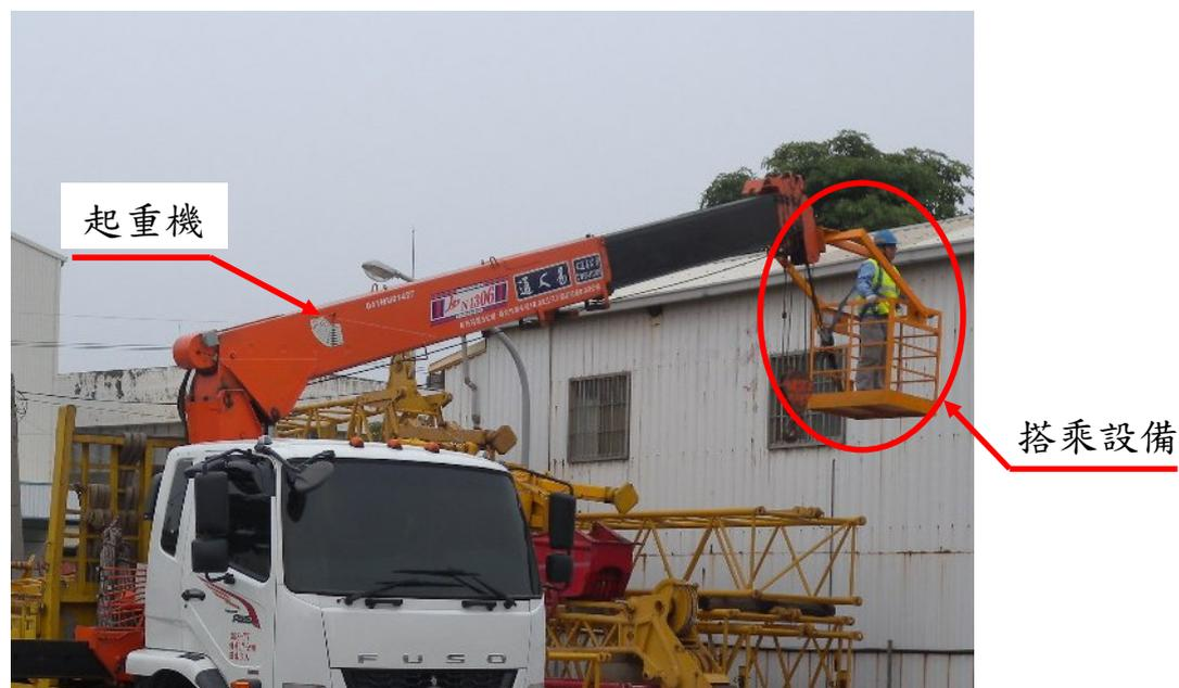
圖 1 起重機吊掛搭乘設備
