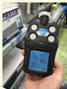
圖十二、環境監測 無清洗作業時，使用直讀式儀器進行環境監測：即時 CO 濃度為 19 ppm、VOC 濃度 20 ppm。
