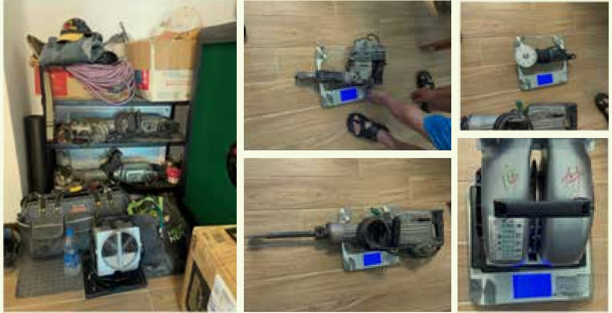
圖四、打石常用工具 (調查其他職業病案件之場訪照片)：大電錘、小電錘、鑽頭、圓盤切割機、工業用電線、工業用抽風扇等。
