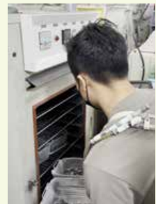
圖十、烘乾 將清洗完成之電路板置入烘乾箱內烘烤。
