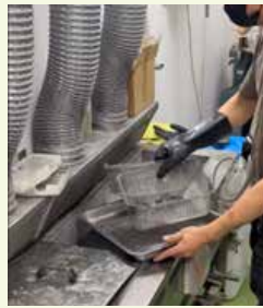
圖六、除膠清洗 1 員工右手穿戴化學手套，將電路板置於籃中浸入化學槽清洗。此時僅配戴普通醫療口罩並未配戴防毒面具。
