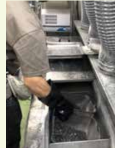
圖七、除膠清洗 2 右手抓握電路板清洗籃放入槽內，以手部晃動方式於槽內清潔，約 3 秒，再換至下一槽體。
