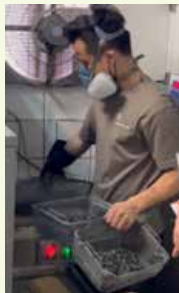
圖八、一般清洗 1 員工僅右手穿戴化學手套，將清洗完成電路板從清洗槽拿出，並用左手置入待清洗之電路板。此時員工有配戴防毒面具。
