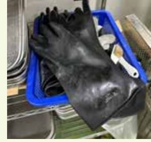
圖四、防護具 1 清洗作業配戴之化學手套，長度約至手肘 (材質不明)。
