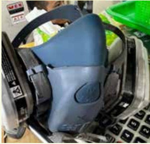
圖五、防護具 2 現場員工配戴之 3M 7502 半面體防毒面罩，使用之濾毒罐為 3M 6001 有機蒸氣濾毒罐。
