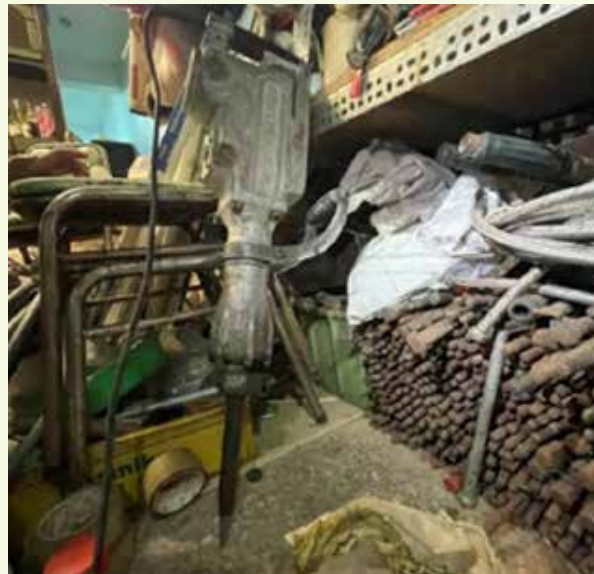
圖三、個案常用之工具，如右下方為大量的鑽頭，中間為打石專用之大電錘。
