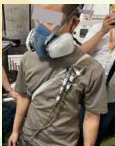
圖十一、採樣設備 個人採樣設備以斜背方式配戴，採樣管盡量靠近呼吸帶。
