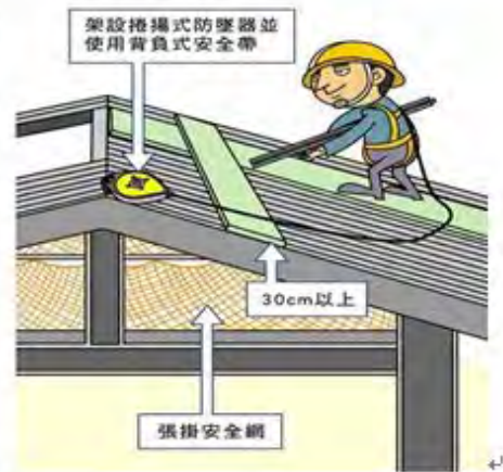
圖二：屋頂作業安全設備圖例
