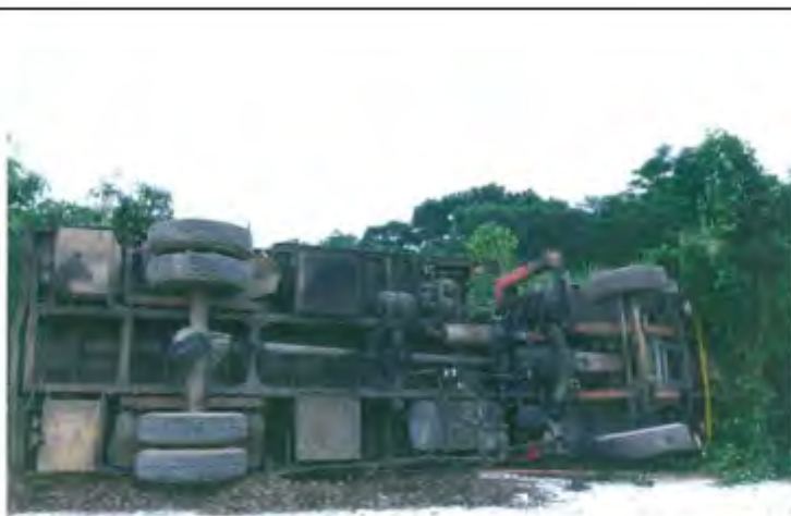
照片 15 噸積載型移動式起重機翻覆情形（臺灣桃園地檢署提供）
