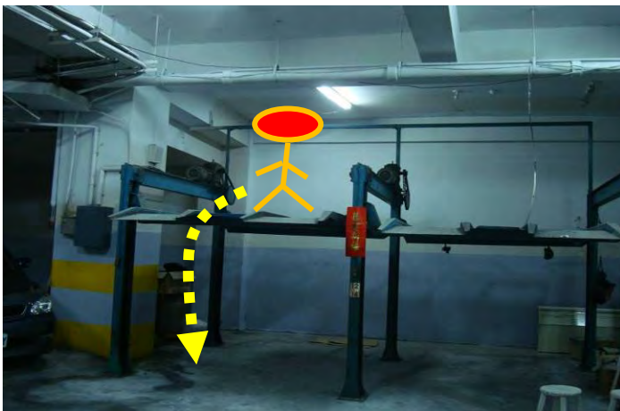
說明：罹災者疑似自車台板上墜落至地面（高度約 1.9 公尺）。
