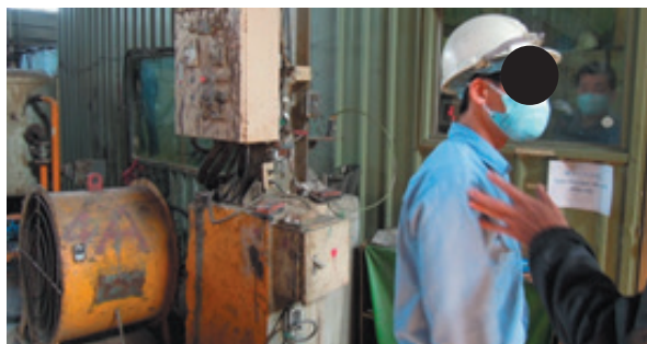
B 廠休息室前自設高壓吹氣設備，員工進休息室前吹去身上鉛塵
