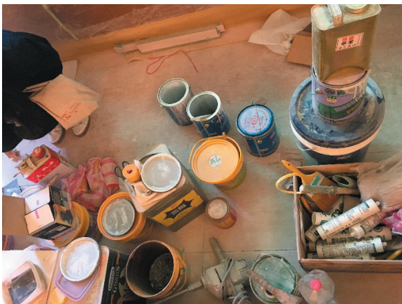
上漆過程需重複以砂紙磨平再上底漆或面漆，每件物品須重複 4 次 ~8 次不等，現場可見底漆、調和漆、色漿、甲苯及香蕉水等，有些使用後並未立即加蓋。
