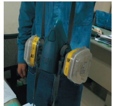
勞工所配戴之呼吸防護具 -N95 等級的綜合氣體濾毒罐
