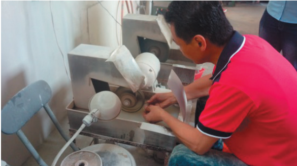
拋光機，將礦石進一步拋光，為溼式作業
