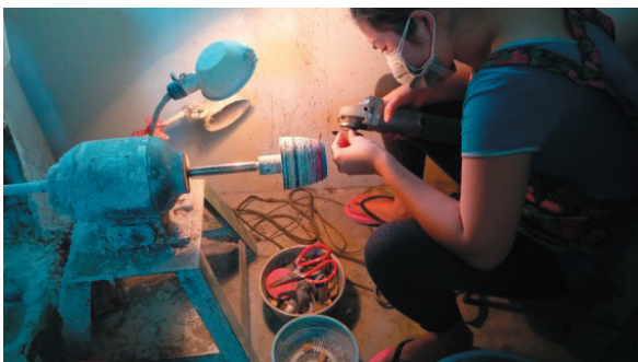
持研磨機手工研磨，為乾式作業
