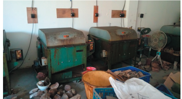
自動切割機，將原石做初步切割成片狀或塊狀
