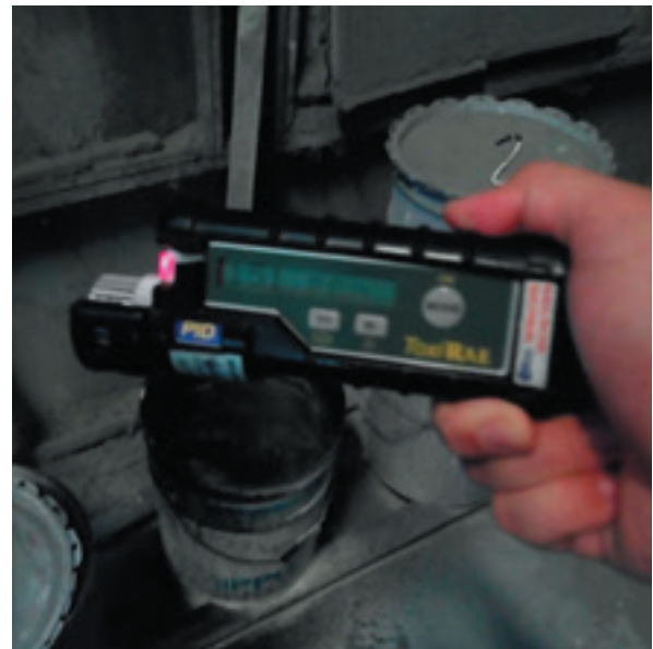
噴漆室外放置底漆及面漆處，上圖為當日入場訪視實地測量 VOC 之數值為 151ppm。
