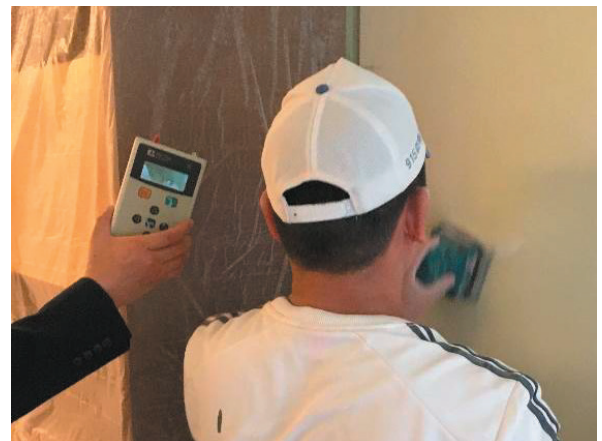
使用電動砂紙機磨平牆面，測得粉塵量最高為 PM1 0.007 mg/m 3 、PM2.5 0.252 mg/m 3 、PM7 0.850 mg/m 3 、PM10 0.895 mg/m 3 、TSP 0.972 mg/m 3 。
