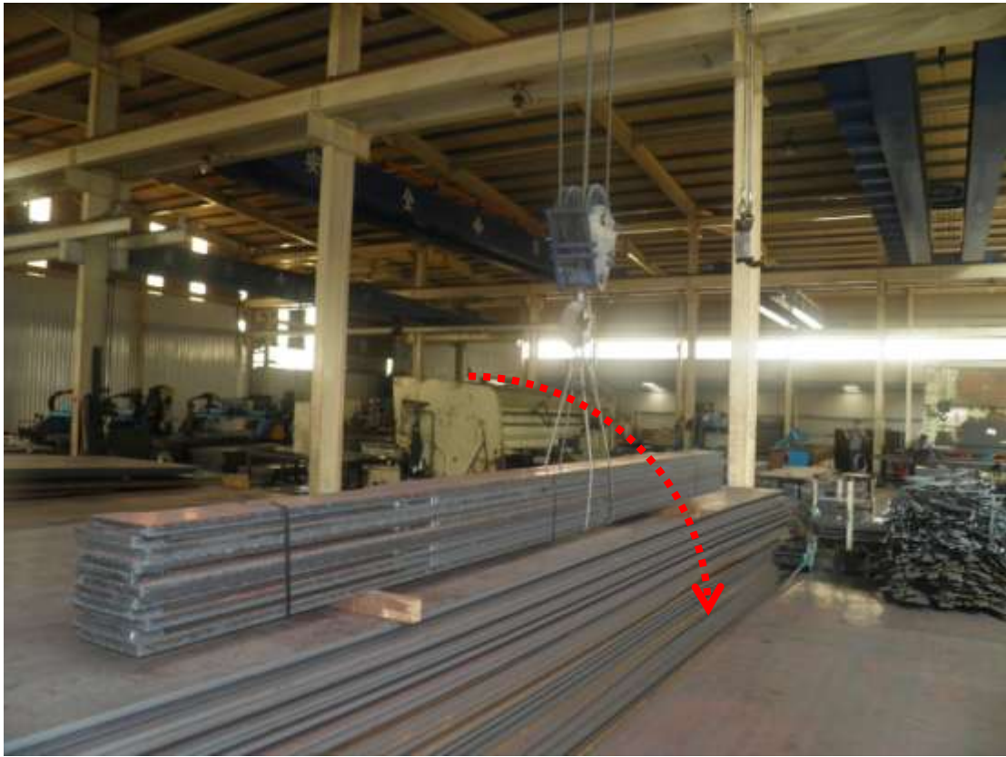
照片 1：重約 3.5 公噸之鐵板成品(災害後現場模擬)
