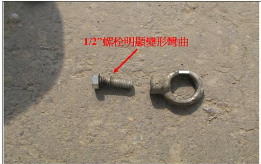
照片 9 隨機抽驗 1 處，拆卸 1/2 吋螺栓及吊環
