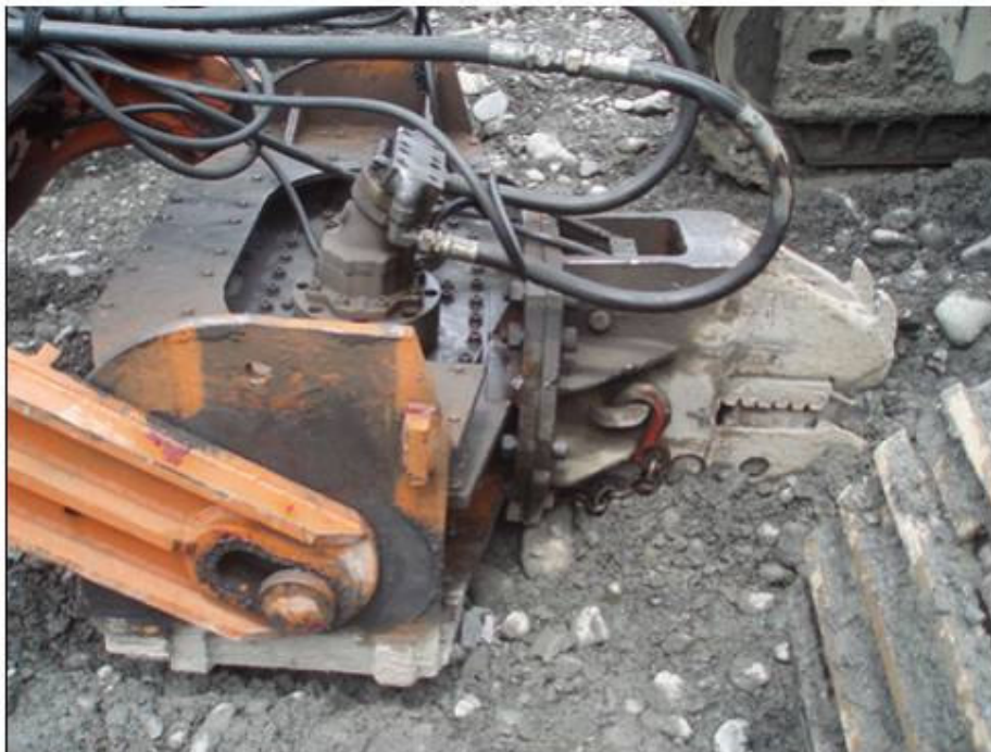
照片五 打樁機夾頭型式圖
