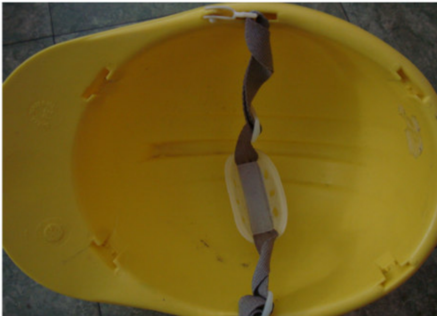
說明五：罹災者所使用之安全帽內部之緩衝裝置已被拆除且安全帽未有符合中央標準局檢驗合格標章(誌)。
