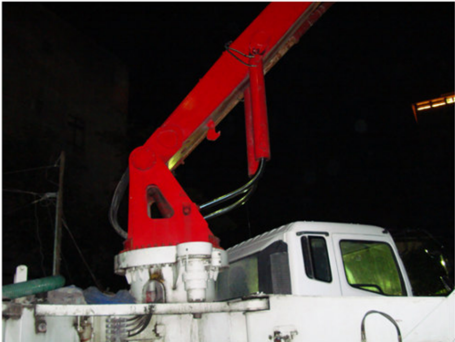
混凝土壓送車第 1 節之油壓缸軸心彎曲變形+
