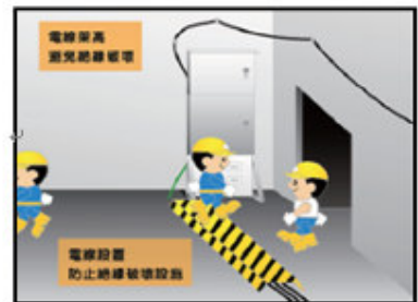
說明：電線架高，並設置防止絕緣破壞設施。
