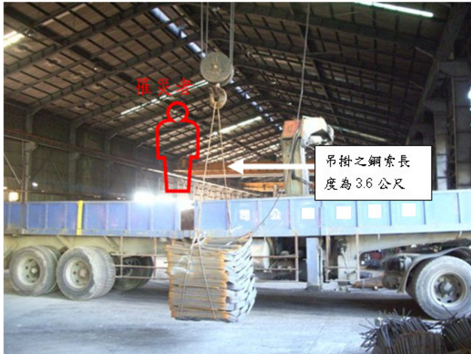
照片 4：放開固定式起重機遙控器動作鈕，固定式起重機因慣性力持續滑動後將罹災者撞落至地面（模擬）。
