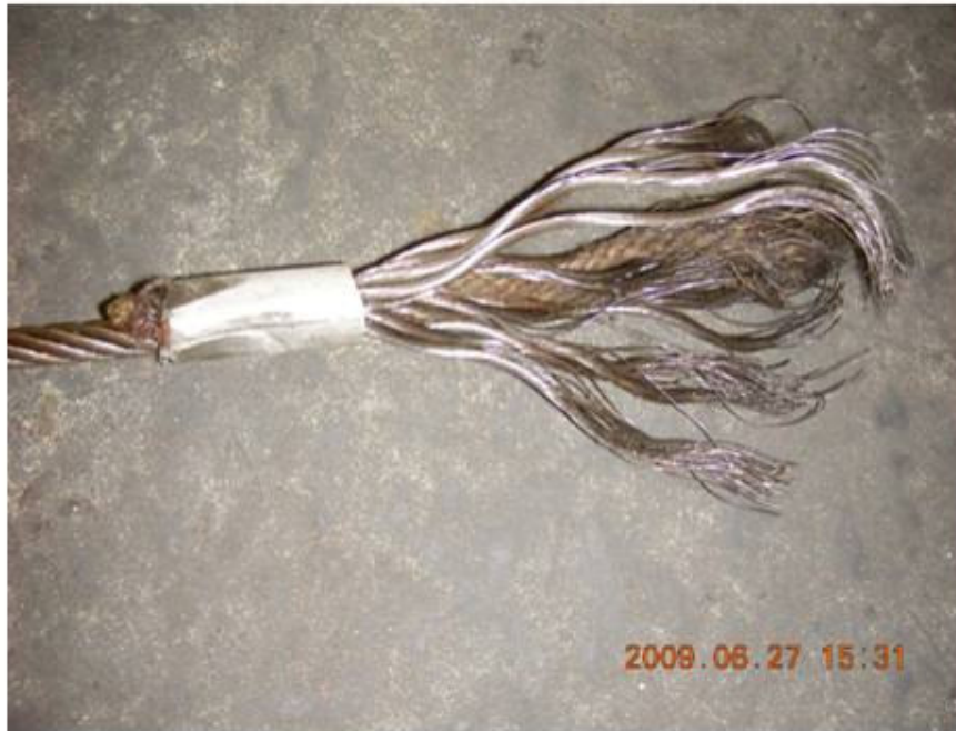
圖 6 事故發生之斷裂之鋼索
