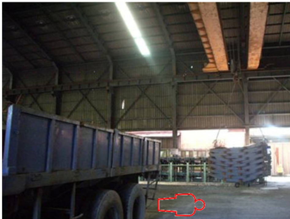
照片 4：放開固定式起重機遙控器動作鈕，固定式起重機因慣性力持續滑動後將罹災者撞落至地面（模擬）。
