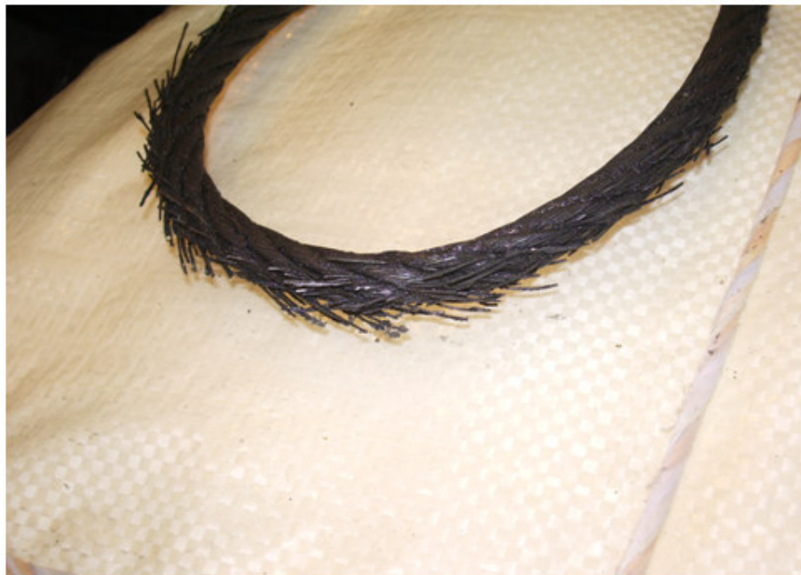
圖 3 斷裂鋼索斷絲情況(發生事故固定式起重機之鋼索)
