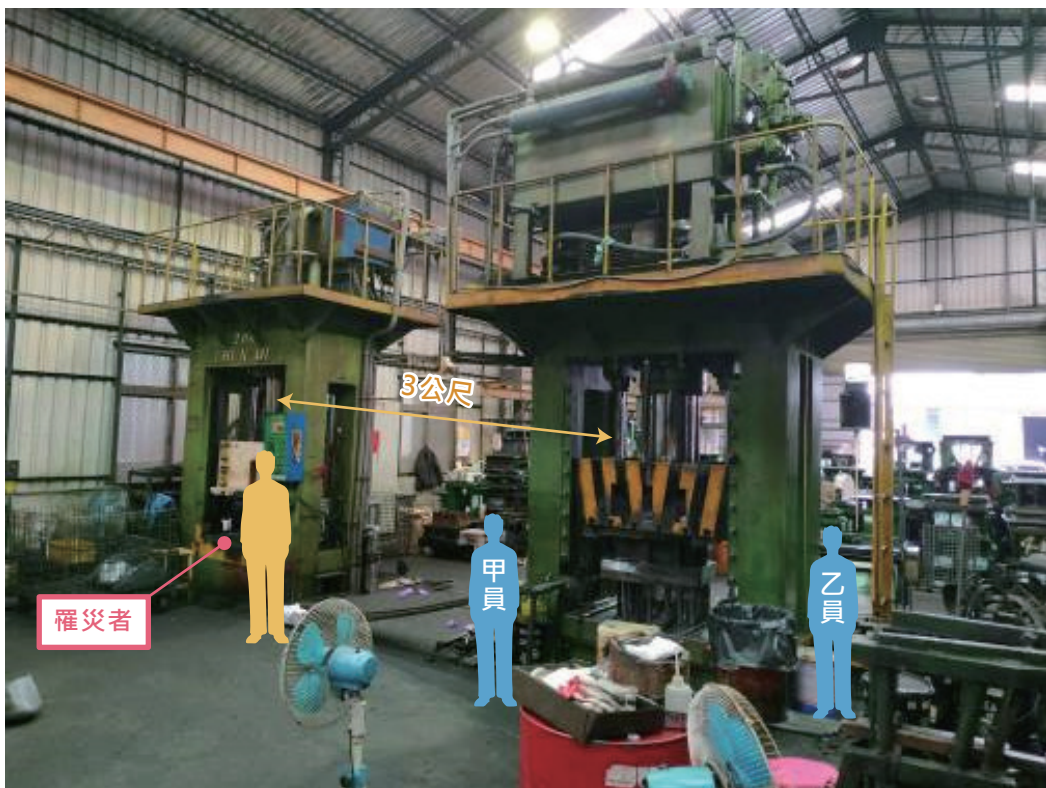
▲ 甲員啟動250公噸油壓衝壓機械衝壓成型為三角油箱立體狀，乙員由該油壓衝壓機械後方取出已成型機車油箱半成品，並利用滑板之高低差滑至距離3公尺之罹災者作業區。
