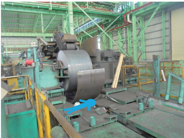
▲ 災害發生處(解捲機入料區)。
