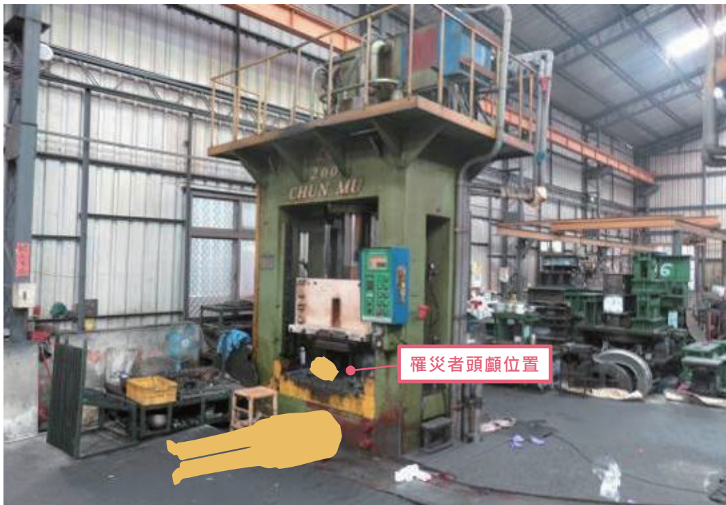
▲ 肇災現場位於200公噸油壓衝壓機械，係屬四柱型油壓衝剪機械。
