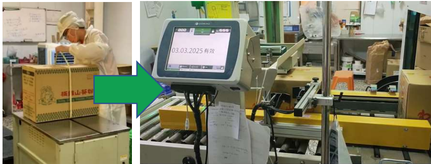
圖 2、導入自動化機台進行箱底及箱頂封箱、噴印日期及打包
