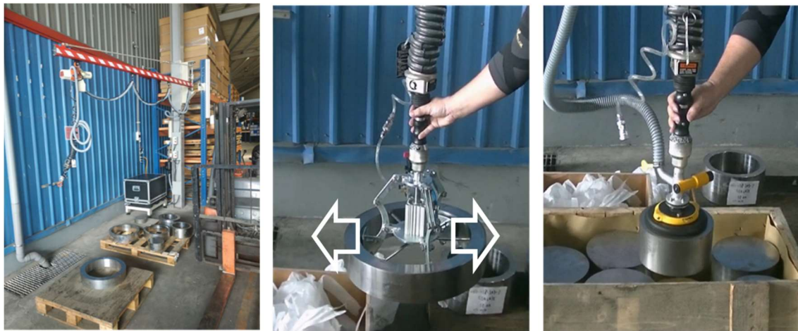
圖 3、改善後員工只需更換省力裝置特殊夾持頭 即可不費力的搬運各式零件
