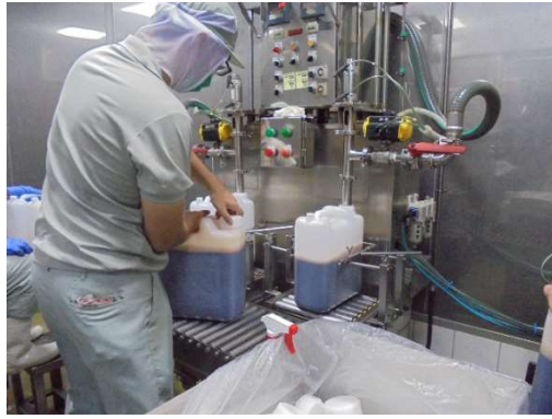
圖 1、改善前作業人員需要徒手將醬油桶蓋子旋緊
