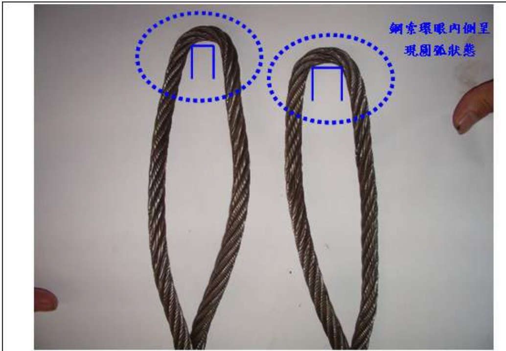
圖 8. 筆災電桿上蓋模未脫落端鋼索兩端環眼狀態照片
