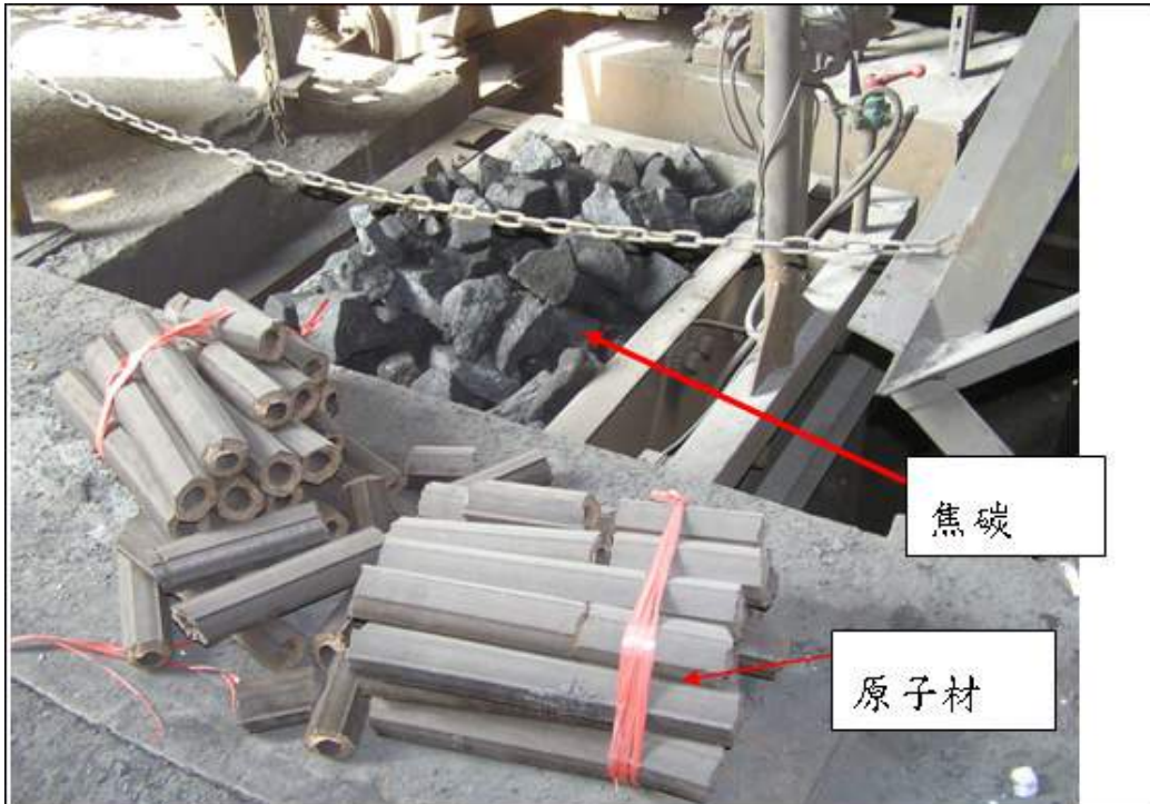
照片 4 熔解爐內部以焦炭及原子材放在紅土上面為燃料
