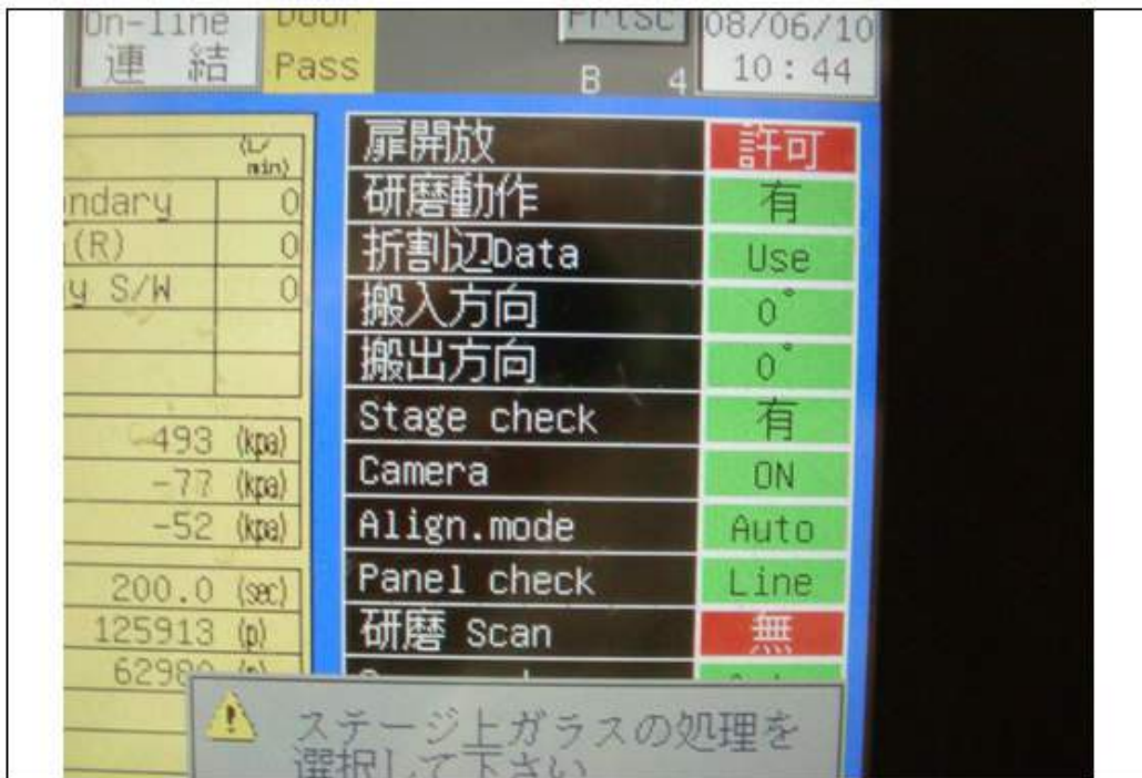
照片三 安全裝置(扉開放)許可，門安全裝置已關閉
