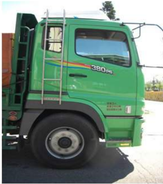
照片 1：罹災者自貨車的腳踏板(距離地面約 100 公分)墜落
