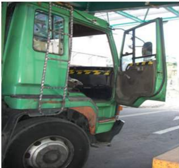
照片 2：貨車助手席側之腳踏板並未設置輔助扶手
