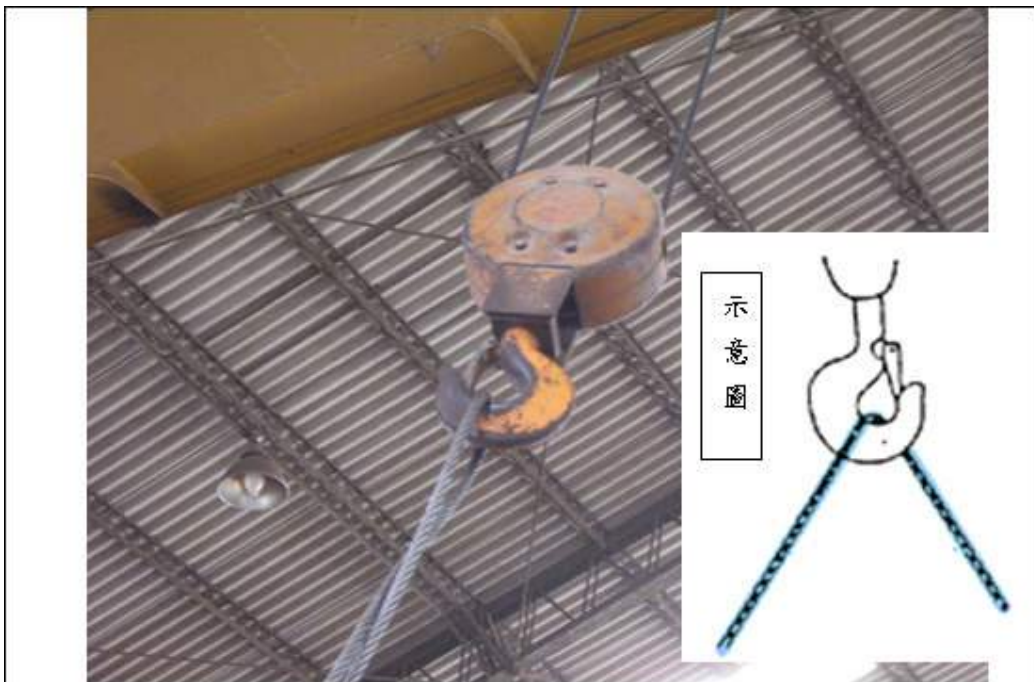
圖 5. 鋼索以環掛方式吊運
