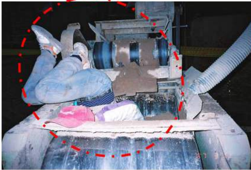
照片 1：罹災者頭、胸、左手全部在中碎土機的两个滾輪間開口下方。
