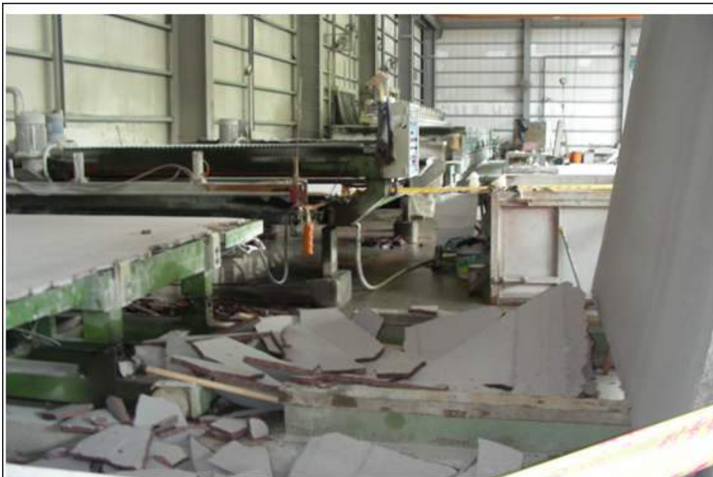
說明 2 磨台機上台區倒立台旁堆置之石板，並無採取繩索相綁或擋樁等防止石板倒塌措施。
