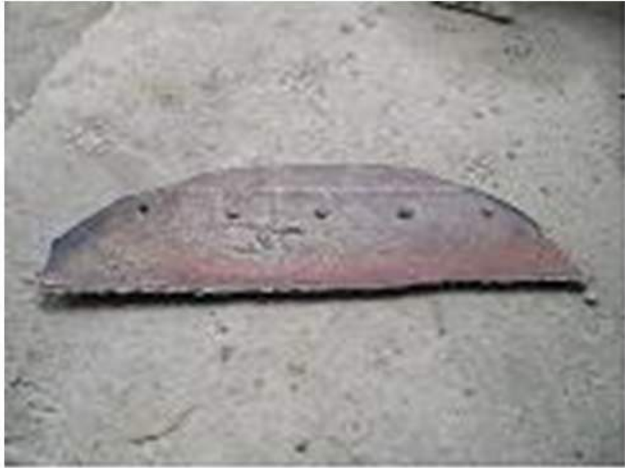
圖 3. 欲焊接脫落之擋料板
