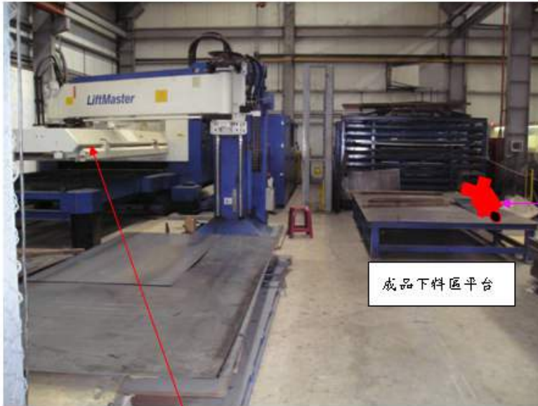
後視圖，雷射加工機機器人手臂可動範圍之外側，未依規定設置圍柵或護圍。
