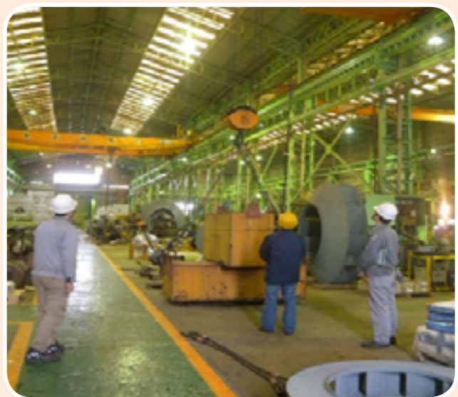
◎ 檢查員實施固定式起重機荷重試驗
