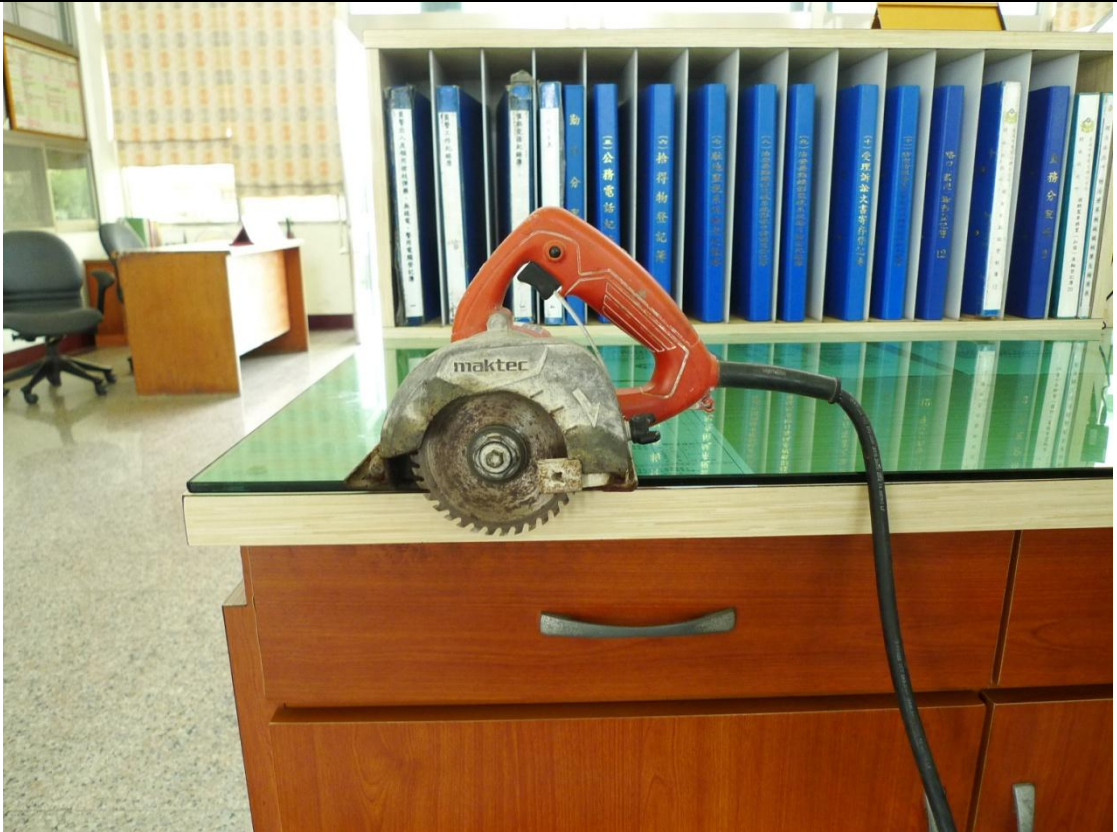
照片四：(四)邱00(自營作業者)所使用之攜帶式圓盤鋸之鋸齒接觸預防裝置未具備可動式覆蓋、未具備平板。
