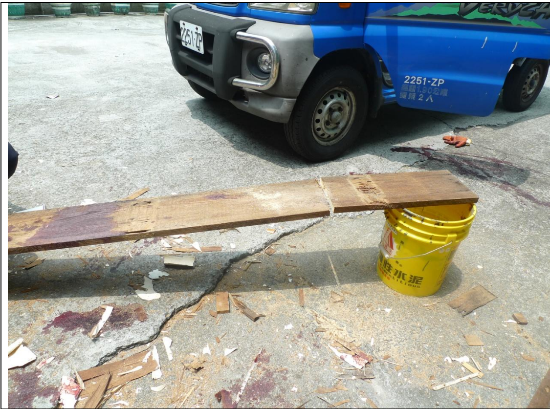
照片七：研判邱 00(自營作業者)欲將該廢棄木材切割數小塊以利清運，其切割時將廢棄木材倚靠在塑膠水桶(高 36 公分)上，使用攜帶式圓盤鋸進行切割(模擬狀況)。
