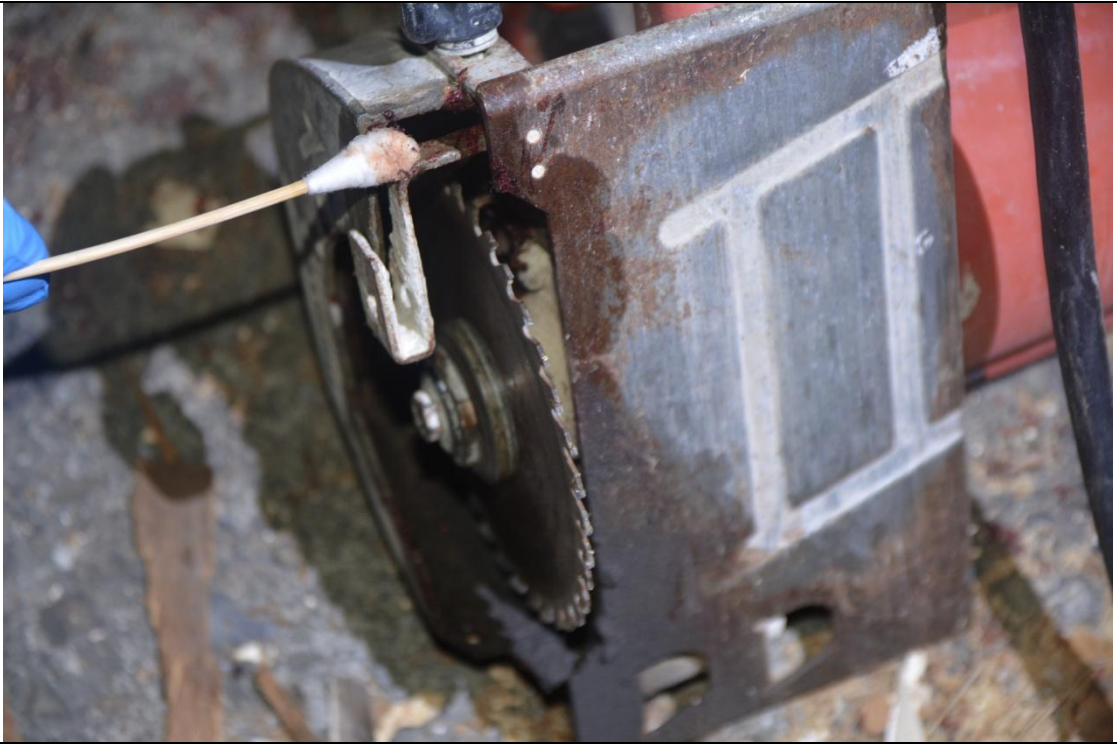
照片三：攜帶式圓盤鋸之鋸片留有血跡及罹災者部分組織。
