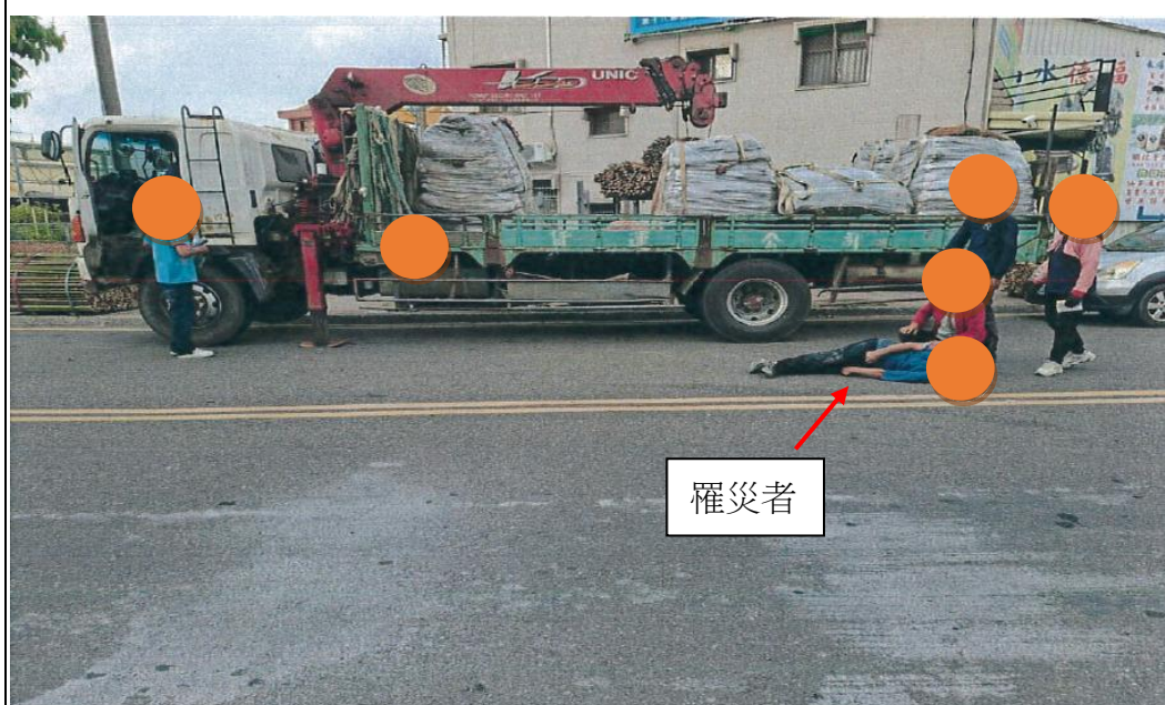
照片 3 王○○被晃動之吊鉤擊中而從站立處墜落至地面。
