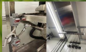
桶槽感測定位 避免誤動風險
