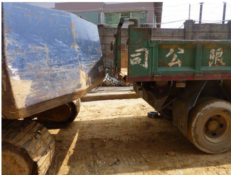
照片 罹災者遭挖土機迴旋時撞擊，身體(腹部)被夾在挖土機與卡車之間
