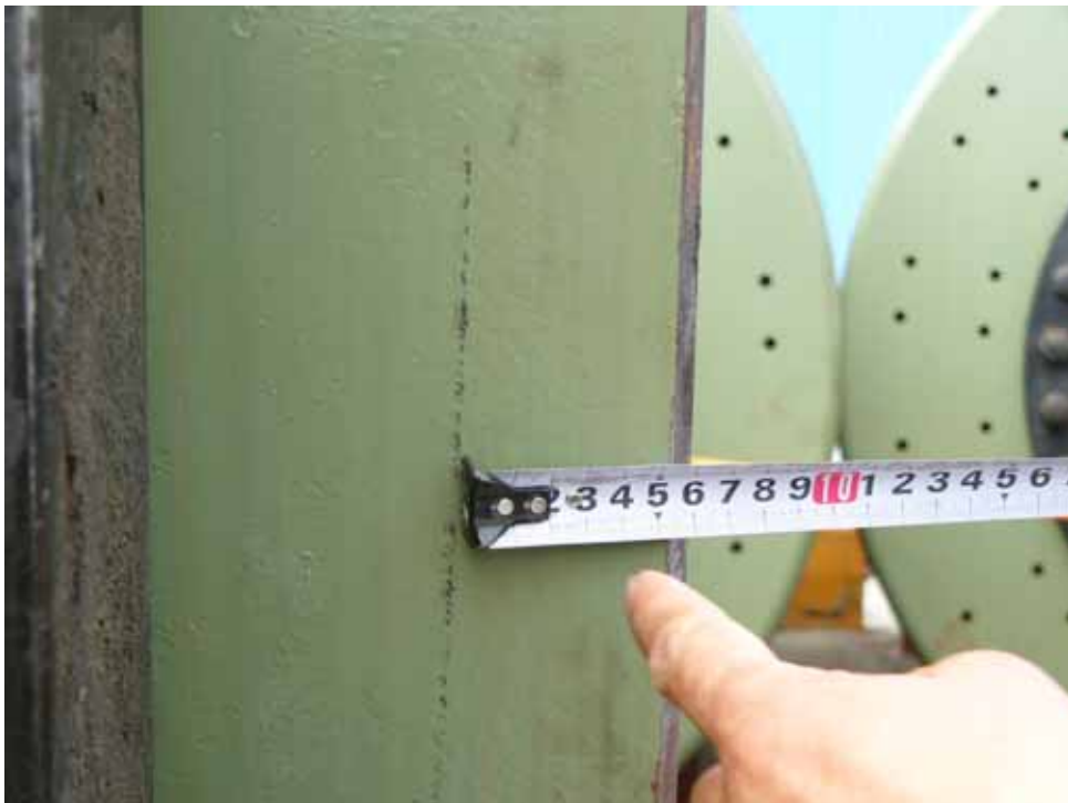
照片 2：災害發生時金屬胎圈僅套著乾燥機體 6 公分深
