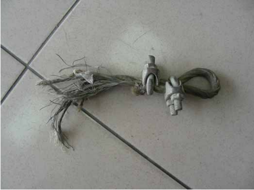
照片 2：斷裂鋼索
