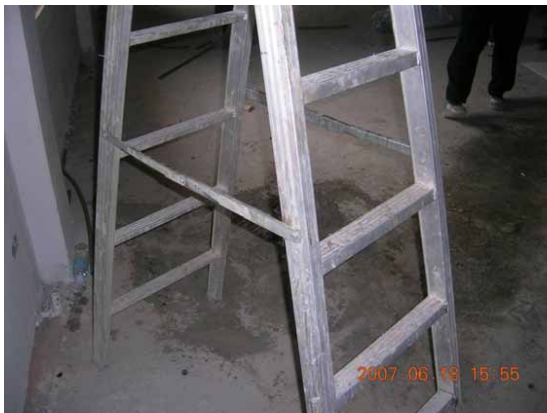
照片 2：罹災者自 7 尺鋁製合梯第 2、3 階之間處墜落
