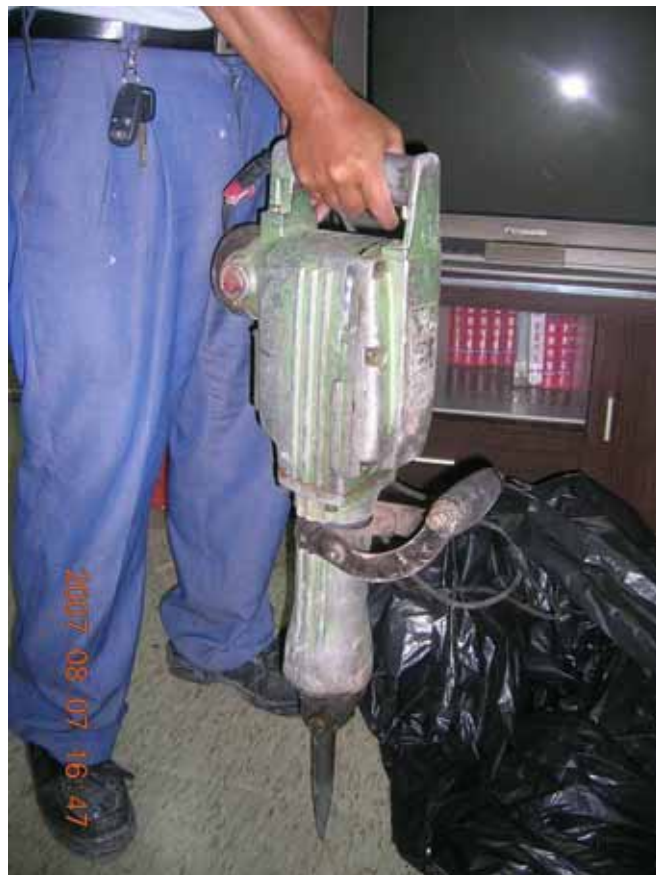
照片 4：罹災者所使用的破碎機外殼部分有漏電現象
