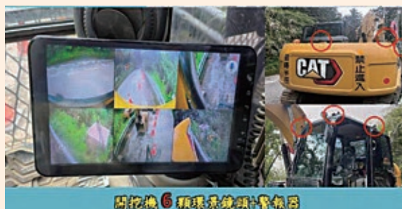
◎ 營建系車輛機械設置警示或監視設備避免作業人員誤入警戒區造成危害
