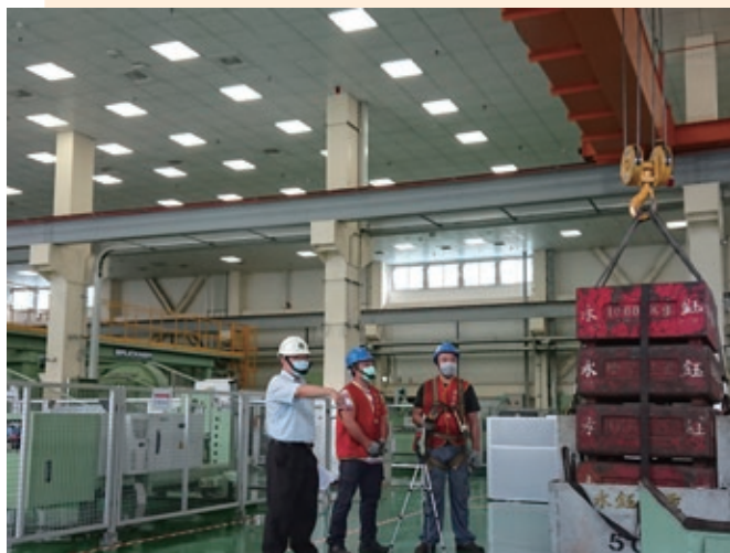
◎ 代檢員對固定式起重機實施荷重性能試驗
