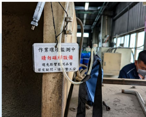
◎ 運用區域採樣，評估作業場所工程控制成效
