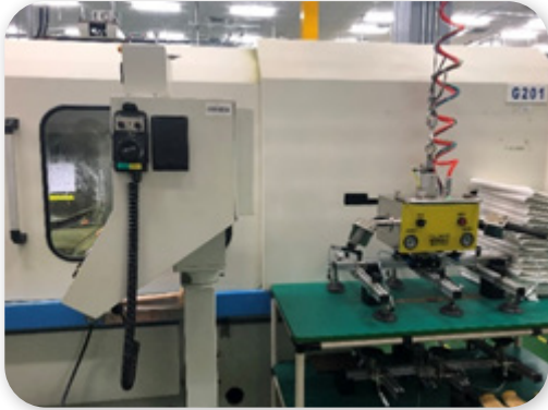
濕式研磨，過程為機台自動化密閉操作。
