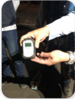
射源屏體位於人員腳邊時， 個人偵檢器計測值 0.7 \mu\text{Sv}
