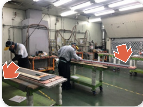
人工清潔細部，雙手持砂紙來回研磨，紅箭頭處為兩座局部排氣裝置設備。
