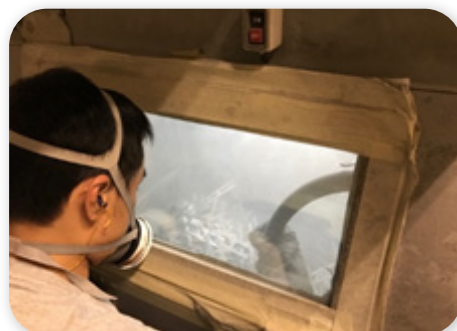
噴砂作業情形： 雙手套進噴砂區內作業，眼睛透過壓克力板操作。
