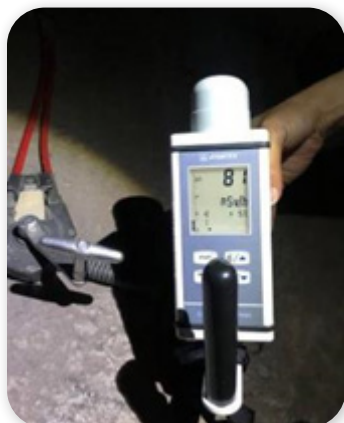
釋出射源前，搖把位置輻射 計測值（屏蔽物：1 道水泥牆）
