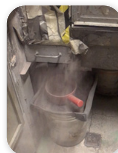
進行噴砂作業時，持續有粉塵溢散出。
