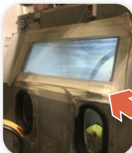
噴砂作業情形： 噴砂雙手伸入手套內進行噴砂作業。且機台無有效密閉。壓克力窗週邊可見膠帶黏貼。
