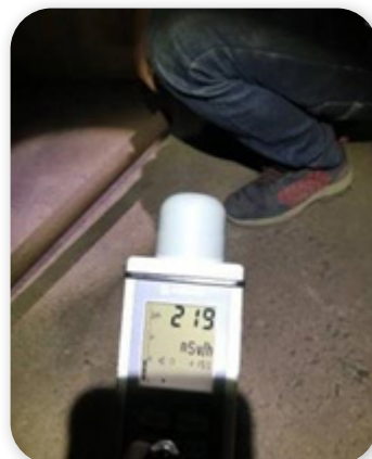
拍攝時人員位置輻射計測值 （屏蔽物：2 道水泥牆）
