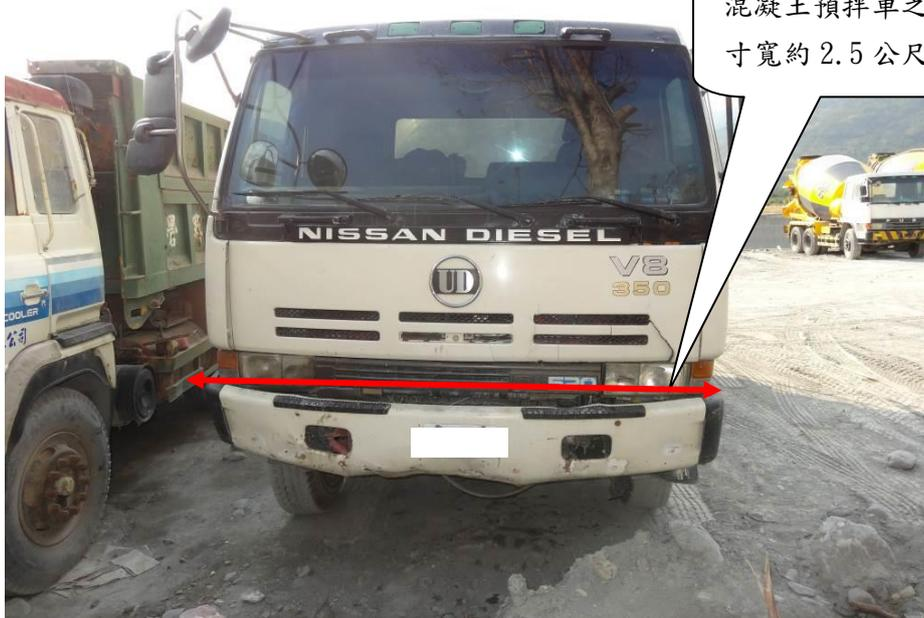
混凝土預拌車之尺寸寬約 2.5 公尺
