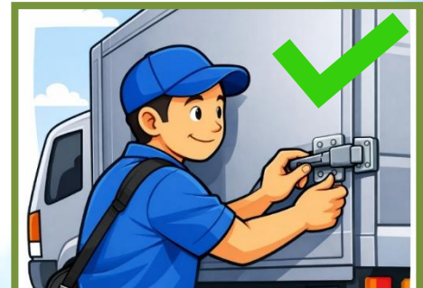
鷗翼門關閉後應 確實使用安全插鎖
