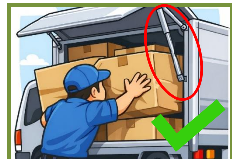
確實將油壓桿完全撐開
