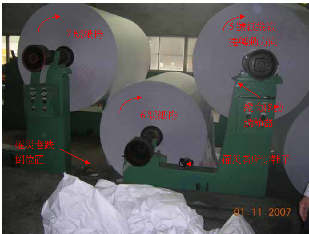
照片 1：罹災者於牽引紙捲紙張時身體不慎碰撞縱向移動調節器，又遭 6 號紙捲支架絆倒，最後倒在 7 號紙捲下方
