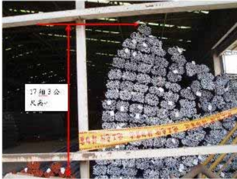
照片 1：罹災者被壓在倒塌的鋼筋下
