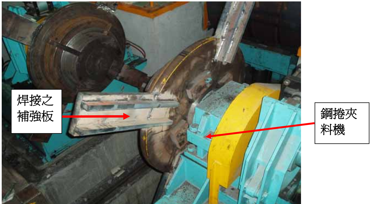
照片 1：罹災者將補強板焊接於鋼捲夾料機上
