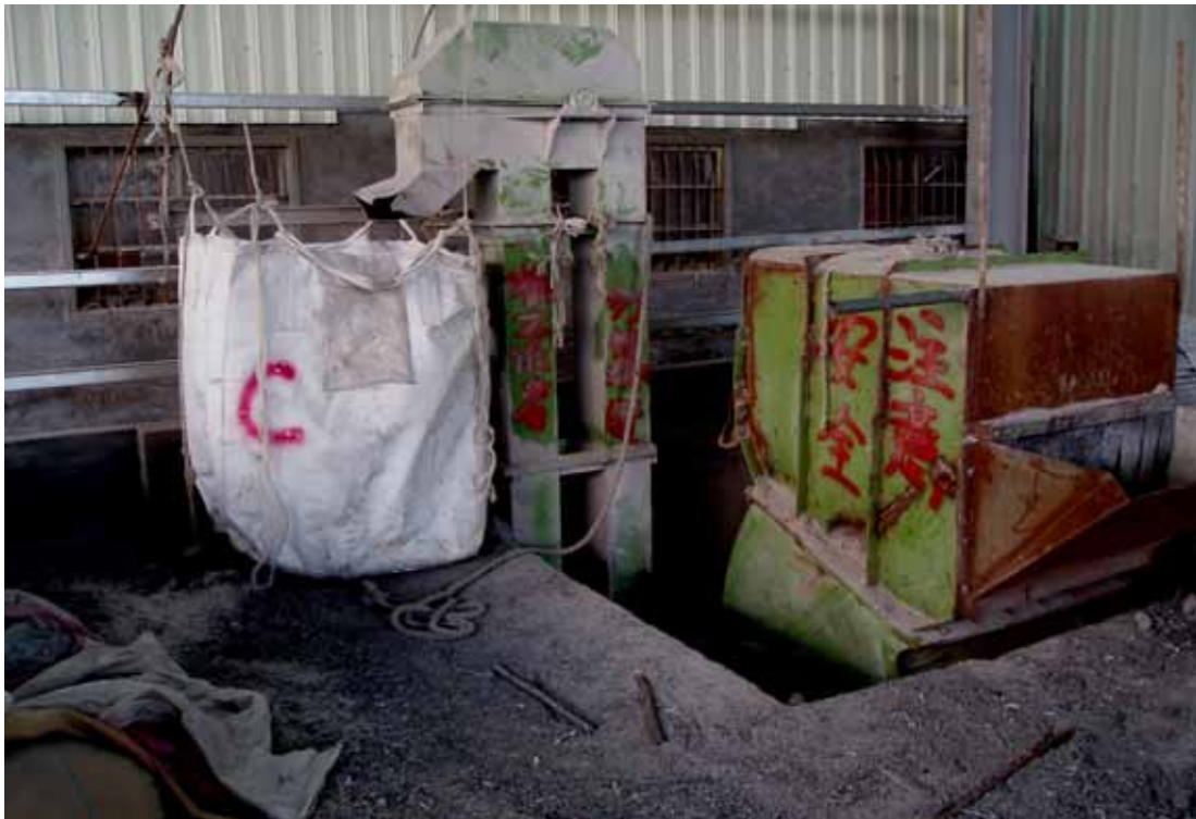
照片 1：罹災者身體被夾於水泥地板與粉碎機外殼之狹縫，狹縫寬度 18 公分，深度 74 公分
