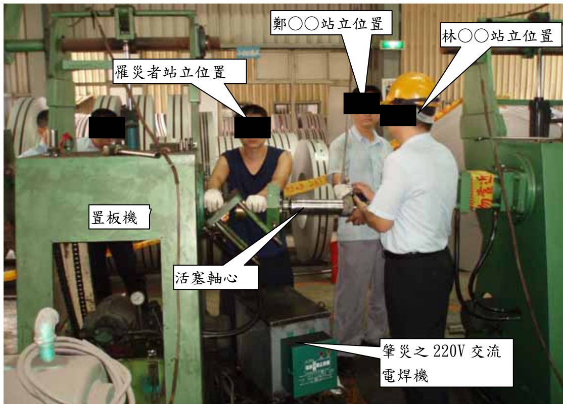
照片 1：說明：模擬罹災者與林○○及鄭○○三人正協力將置板機活塞軸心抽出時，各自所站立之位置示意圖，工作現場有電焊機 1 部，災害發生當時該電焊機未關閉總電源
