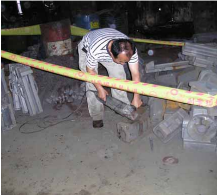
照片 1：模擬罹災者當時工作時，拿手提式研磨機彎腰在研磨金屬鑄件
