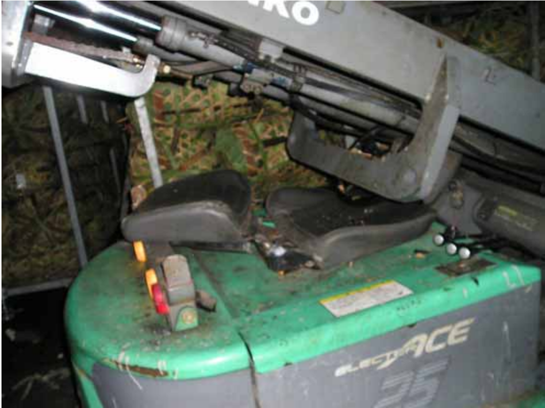
照片 1：罹災者被所駕駛之荷重 2.5 公噸電動堆高機之桅桿壓住， 當時罹災者坐在駕駛座上
