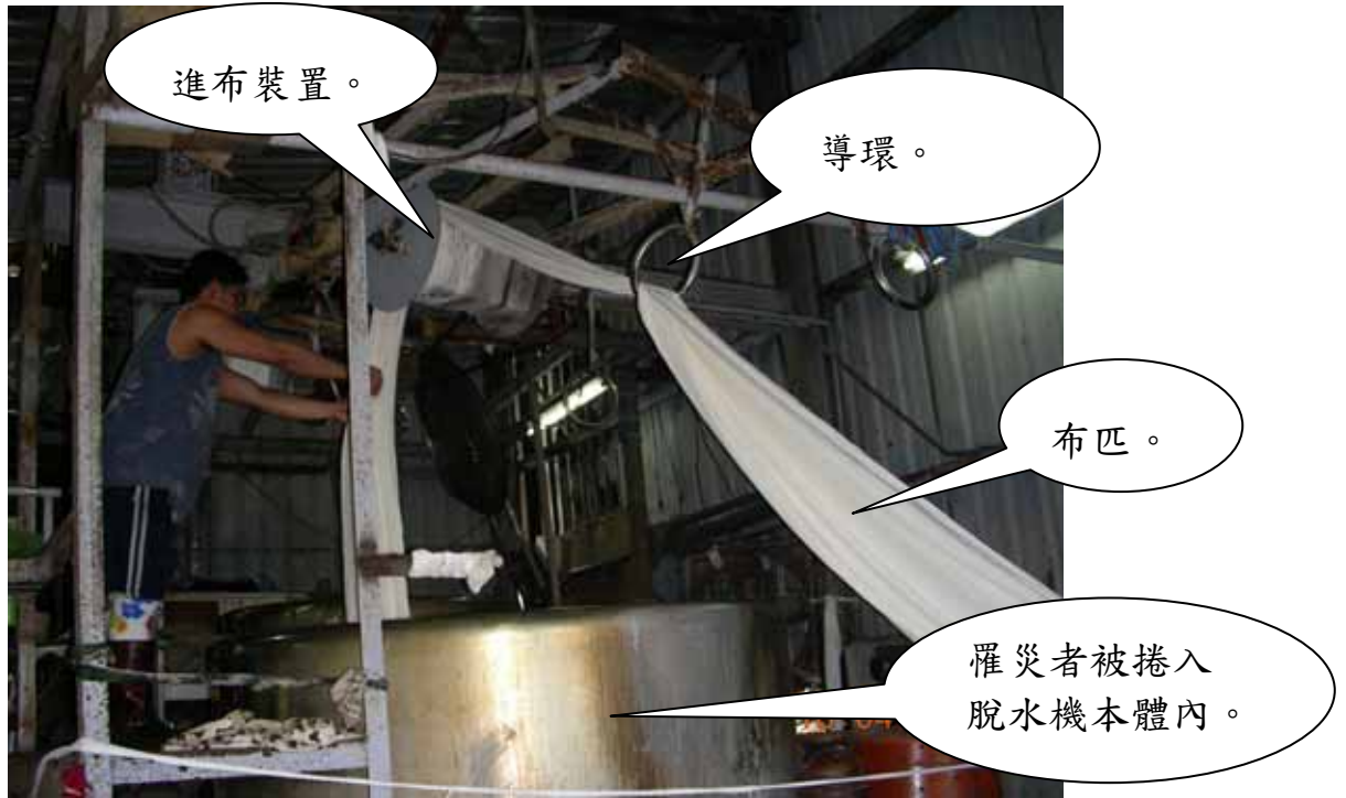
照片 1：罹災者同事模擬罹災者操作進布裝置將布匹經導環、進布裝置進入脫水機。
