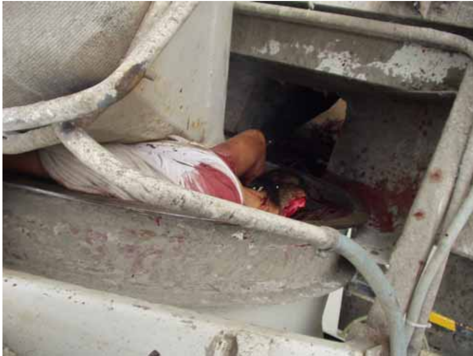
照片 1：勞工被預拌車出料口捲入導致頭顱破裂(未切除入料斗)
