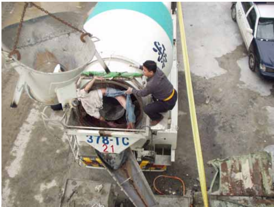
照片 2：勞工清除預拌車出料口混凝土結塊被捲致死(已切除入料斗)
