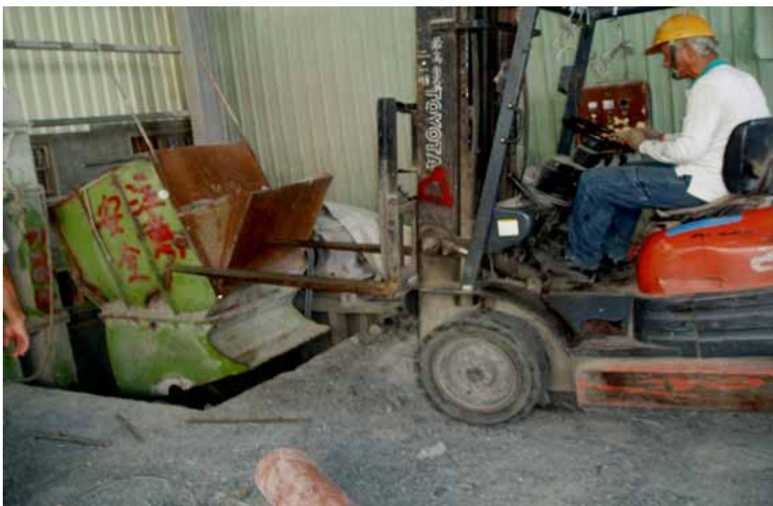
照片 3：清理粉碎機之前，先以堆高機貨叉將粉碎機上座頂開
