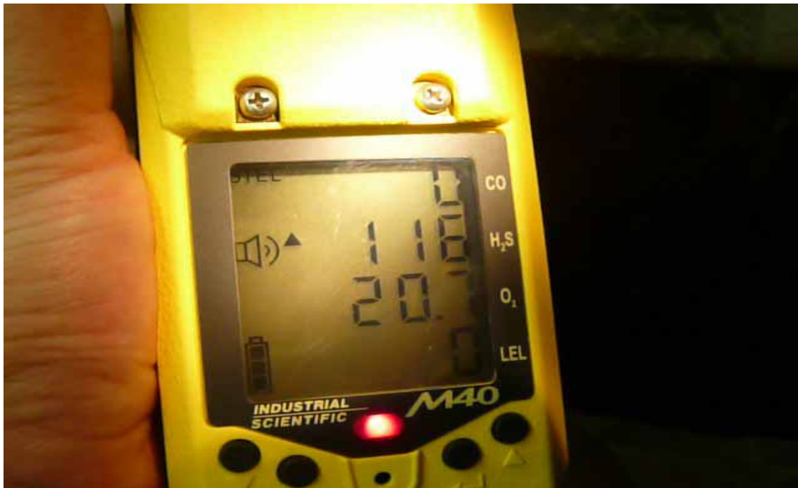
照片 1,2：災害現場經氣體測定器量測結果：硫化氫 (H 2 S)：116ppm；一氧化碳 (CO)：0 ppm；可燃性氣體 (LEL)：0%；氧氣 (O 2 )：20.7%
