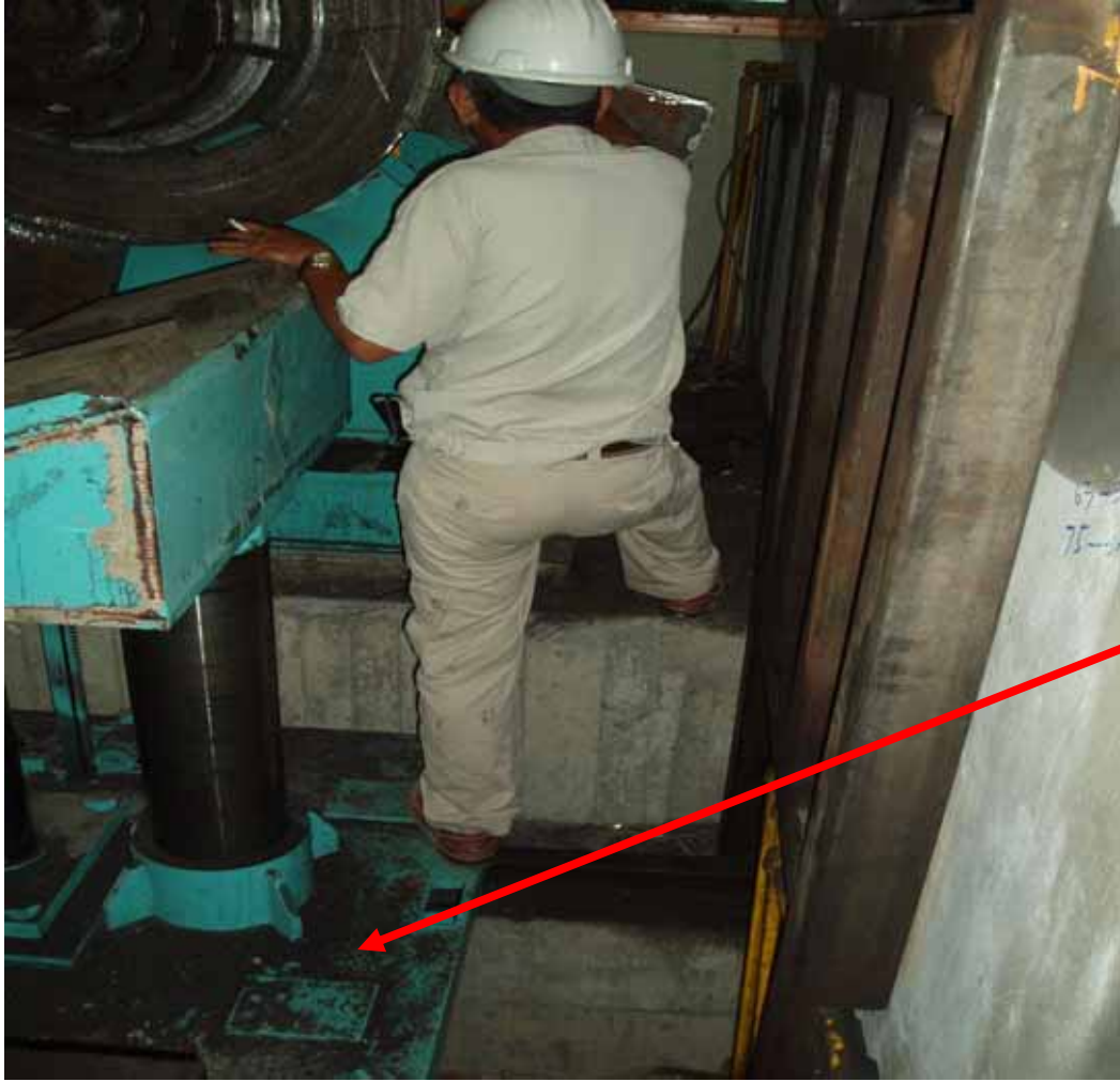
照片 3：罹災者焊接鋼捲夾料機補強板時，可能一隻腳踏在搬運臺車上，另一隻腳踏在地板上。(模擬如照片)
