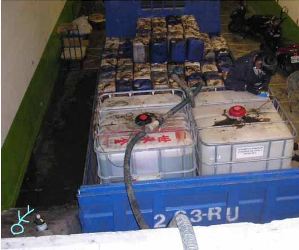
照片 1,2,3：災害現場經氣體測定器量測結果：硫化氫 ( \text{H}_2\text{S} ): 116ppm；一氧化碳 ( \text{CO} ): 0 ppm；可燃性氣體 (LEL): 0%；氧氣 ( \text{O}_2 ): 20.7%
