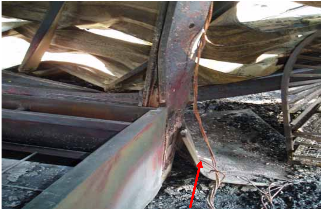
照片 3：2 號超音波清洗機右側板往外翻，研判其內部曾產生爆炸所引起
