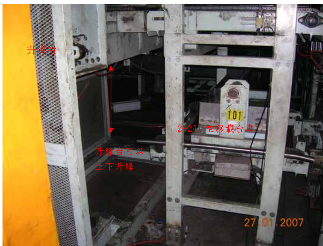
照片 1：罹災者遭下降之編號 2-1A 之 L/F 升降台及 2-2A1 空移載台台車與齒輪輸送設備之間夾住
