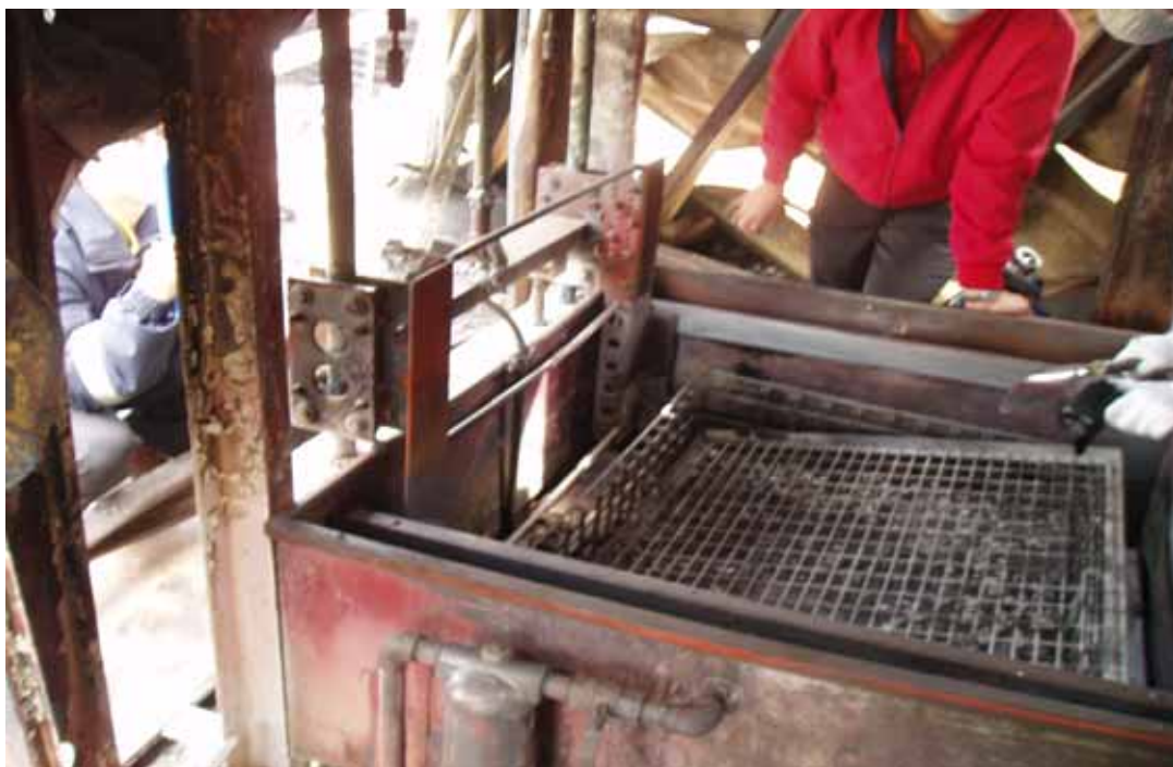
照片 2：肇事之 2 號超音波清洗機內裝清洗劑為異丁醇，內槽尺寸長寬均為 110 公分，深 50 公分，容量約為 0.6 立方米
