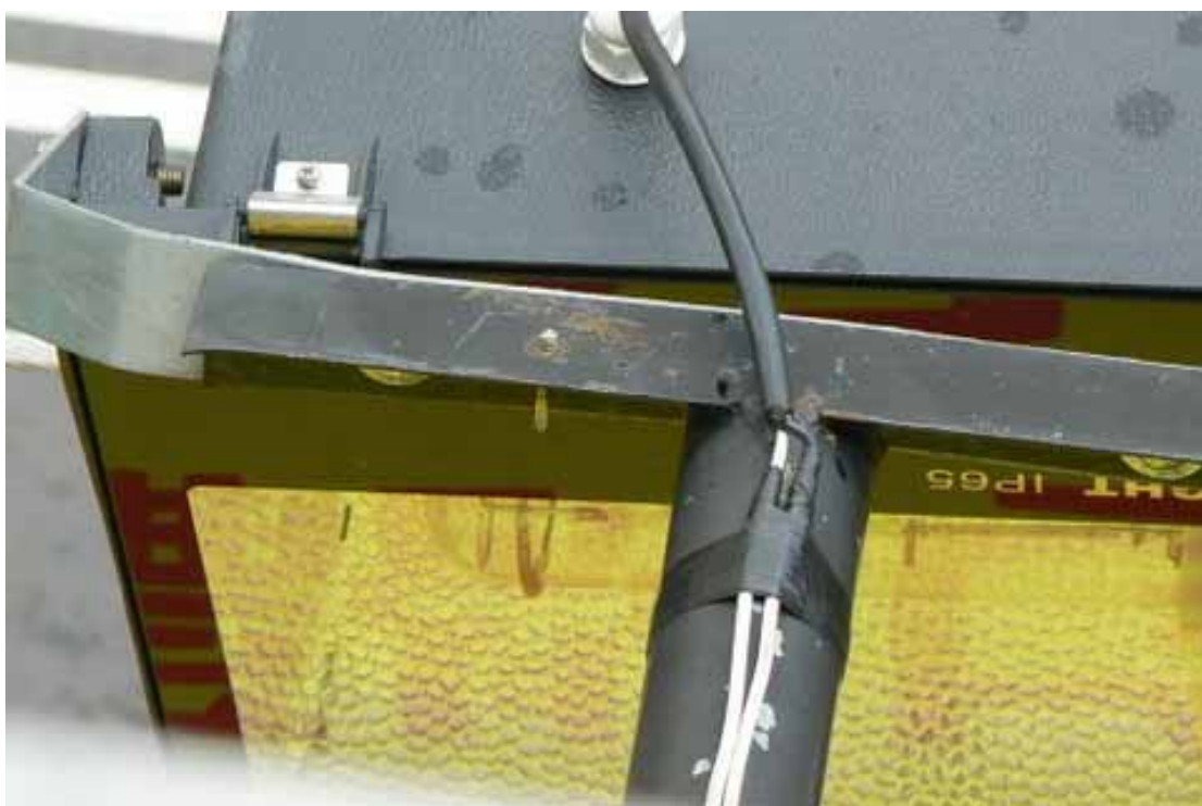
照片 2：右側投射燈支撐用鐵架脫離後燈架上留下之自攻螺絲
