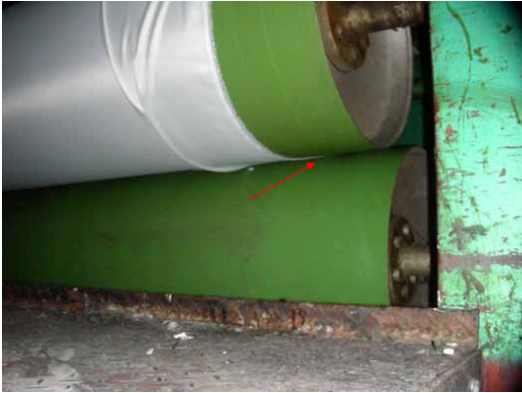
照片 2：災害現場近照(冷卻輪有一小間隙)
