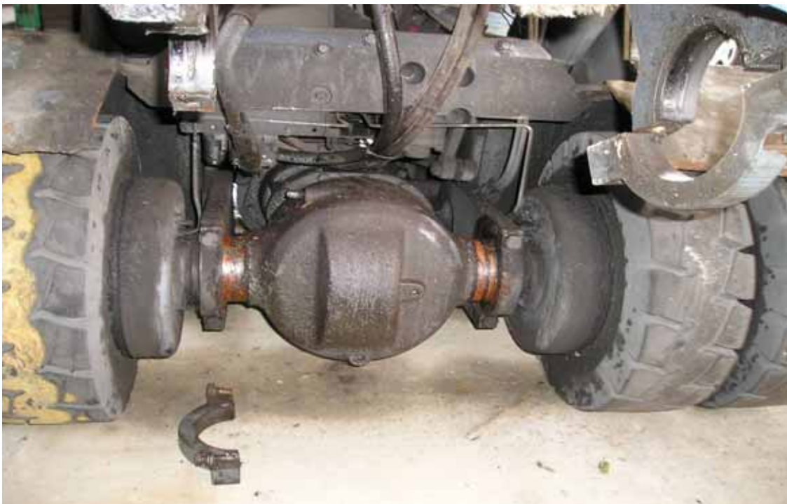
照片 2：原固定於前車軸左右兩側之半圓型底座與另一半圓型夾塊(左右各 1)， 因 4 只固定螺栓金屬疲勞致損壞而脫落
