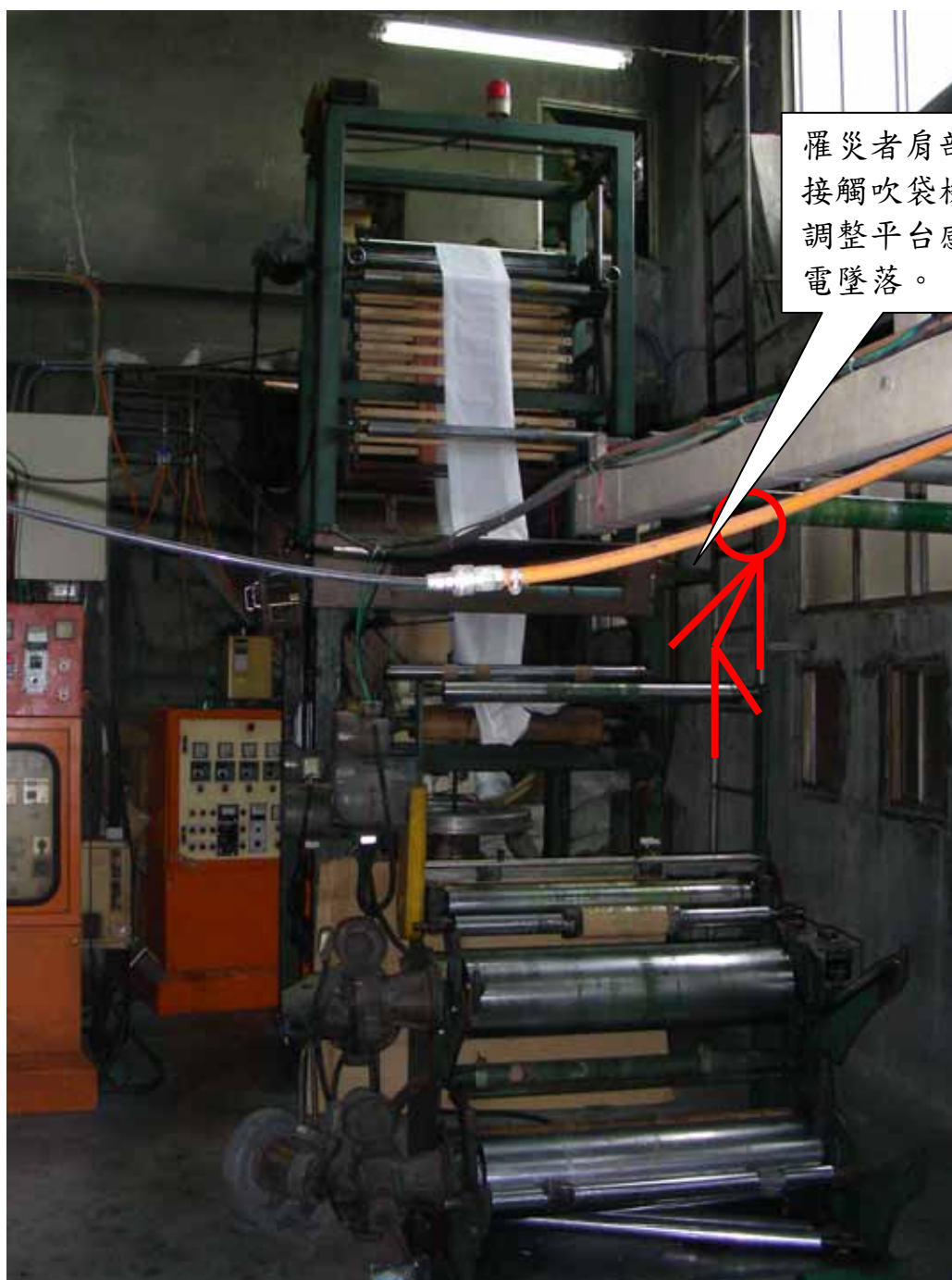
照片 1：班長△△△稱： 96 年月 3 日 10 時左右，我請罹災者○○○調整他負責機台之塑膠袋位置，須由爬梯爬上調整平台。另由署立台北醫院診斷證明可證明罹災者○○○肩膀碰到漏電吹袋機調整平台感電電擊性休克墜落致死
