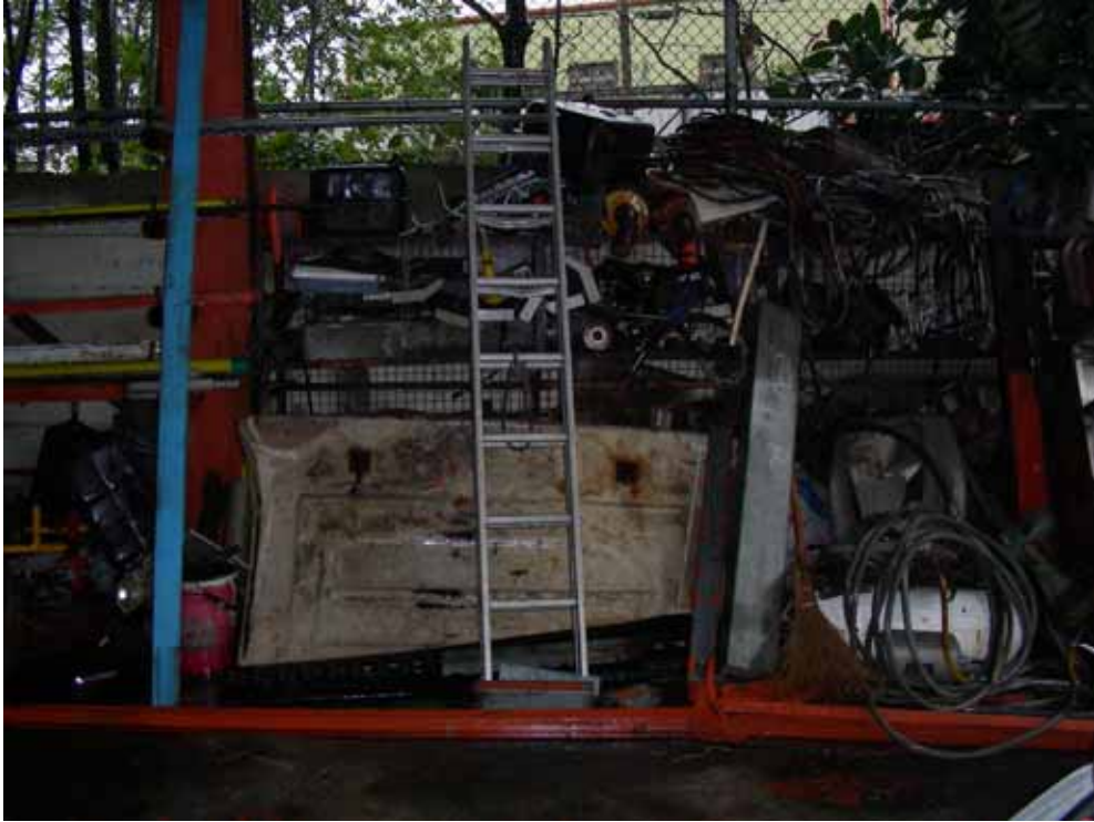
照片 2：罹災者當時使用之合梯，其合梯有顯著之損傷且兩梯腳間未有繫材扣牢
