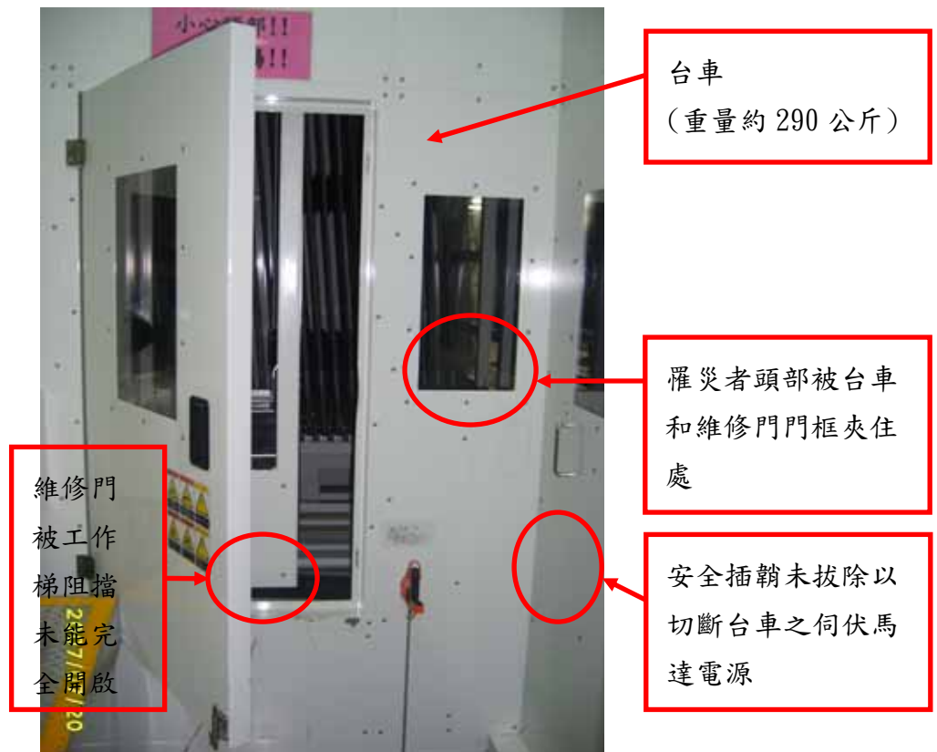
照片 1：災害發生處所：機械設備之維修門。罹災者站立於門外，上半身探入台車行走之軌道艙進行故障排除作業時遭台車撞夾致死
