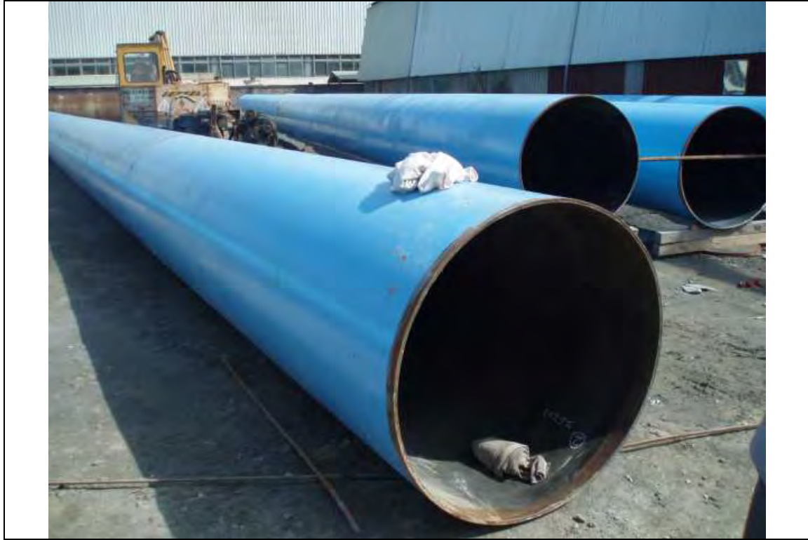
說明三 照片 3：肇災時勞工係以抹布從事鋼管(直徑 103 公分、厚度 2 公分、長度 20 公尺、重約 8 公噸)擦拭清潔作業，肇災後所用之抹布約放於此處。
