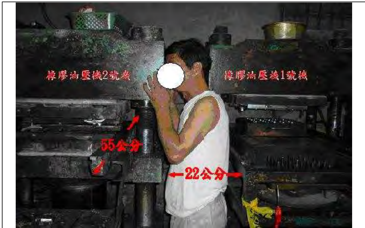
照片 模擬當時罹災者位置(橡膠油壓機 1 號機與 2 號機間距約：22 公分；2 說明 號機寬度約：55 公分)。
