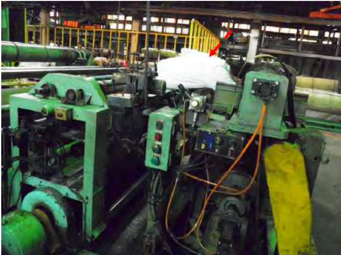
照片：罹災者右手遭捲取機構捲入之情形(該公司勞工模擬當時情形)
