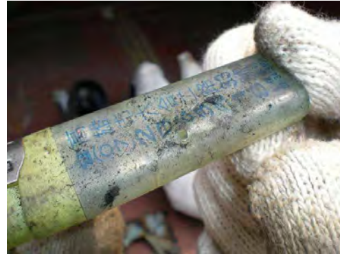
事故現場所拾獲之打火機，打火機上有燒熔之孔洞。
