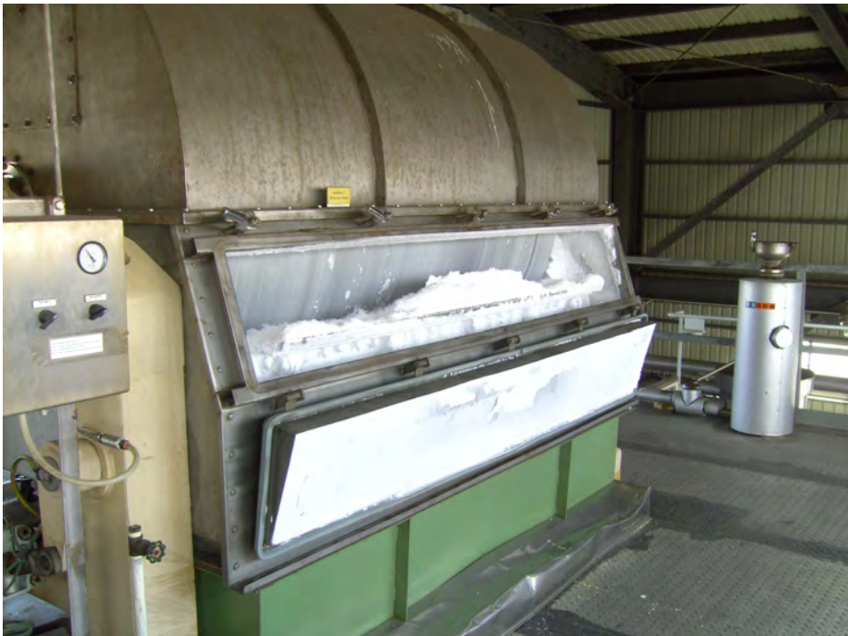
照片 2；三樓打開製片機側蓋，清理內部積存之 PTBP 片狀、粉狀物。
