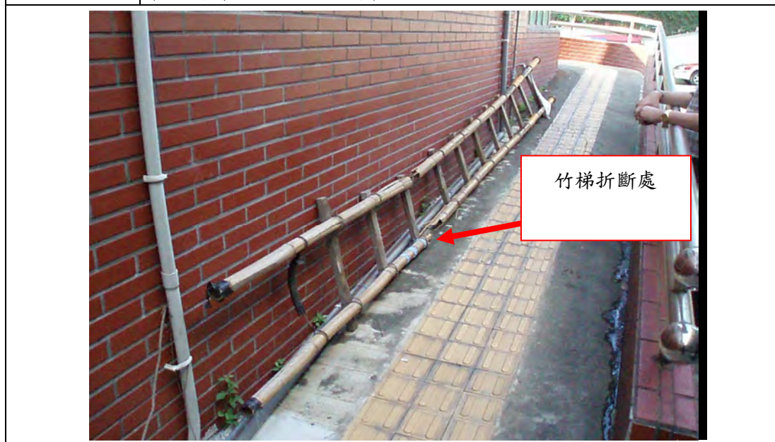
照片二 罹災者洪○○從事市內電話查修作業所使用之竹梯長5.1公尺、寬0.55公尺、梯距為0.35公尺,災害發生後,遭扣於○○市警察局○○派出所暫放之竹梯已折斷。
