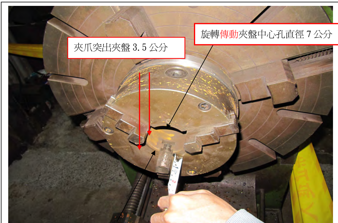
說明二 照片 2：肇災時係將橡膠輥輪之一端置於旋轉傳動夾盤之固定夾盤，該夾盤係三夾爪型式，其中心孔直徑 7 公分及夾爪突出夾盤 3.5 公分。
