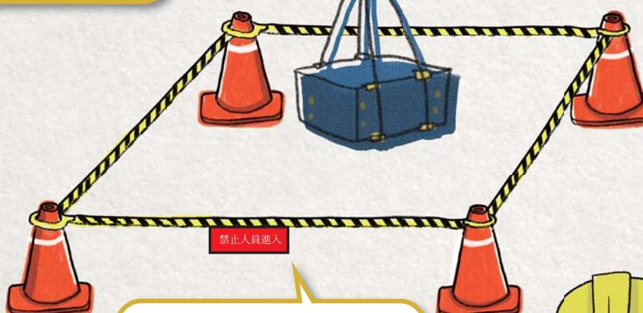
固定式起重機作業時，應採取防止人員進入吊舉物下方及吊舉物通過人員上方之設備或措施。
