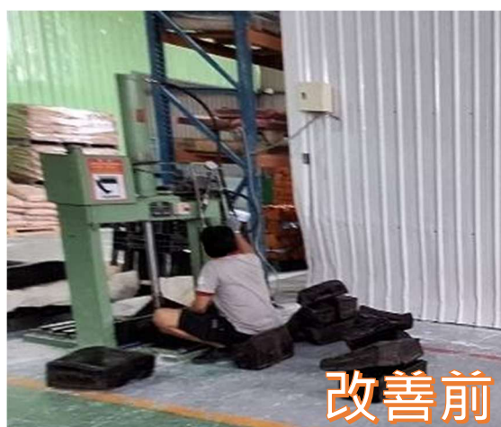
圖四、改善前於地面進行切割作業，改善後墊高切割機台，避免勞工作業時，因姿勢不良造成之危害
