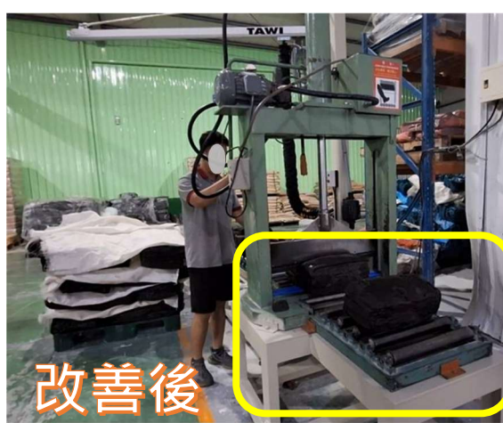
圖四、改善前於地面進行切割作業，改善後墊高切割機台，避免勞工作業時，因姿勢不良造成之危害
