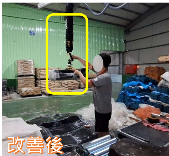
圖三、改善前以人力搬運物料，改善後導入省力臂搬運物料
