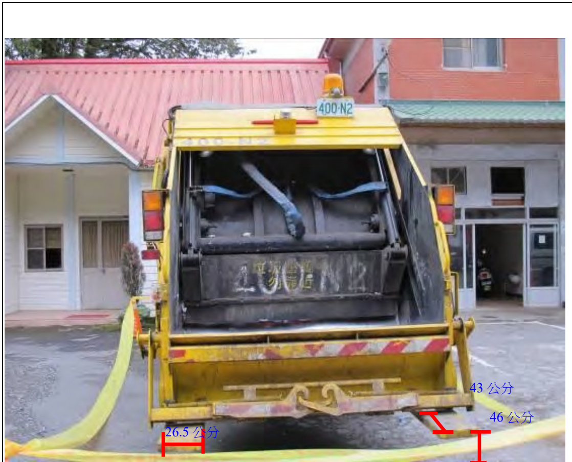
說明 照片二：肇災車輛為車號 400-N2 的壓縮式垃圾車，車後方形踏板長 43 公分，寬 26.5 公分，距路面高度 46 公分。
