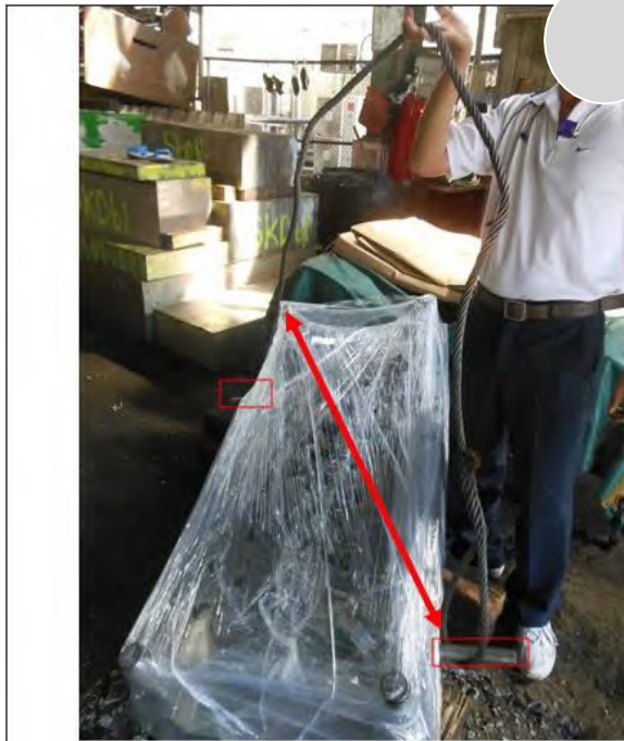
說明：吊掛示意圖(僅以斜對角勾吊)
