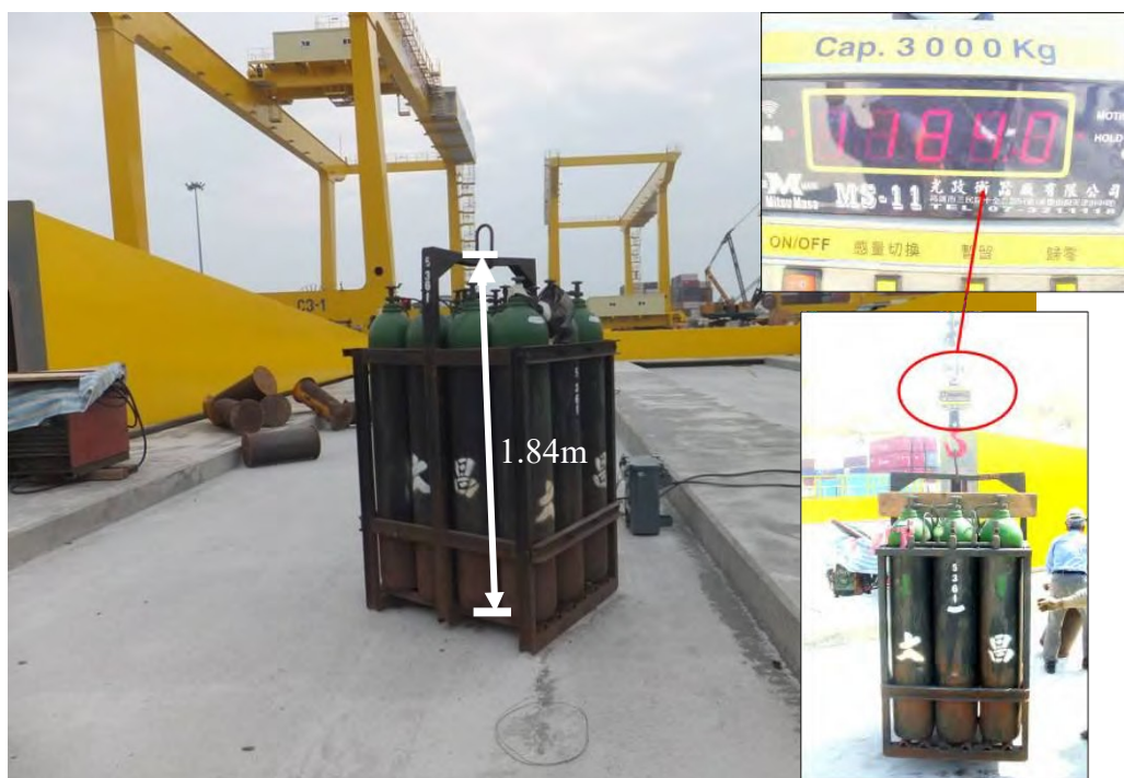
照片2 肇災時所吊掛之集合式CO 2 鋼瓶共有12隻鋼瓶，外框架高度1.84m，總重 1184kg。
