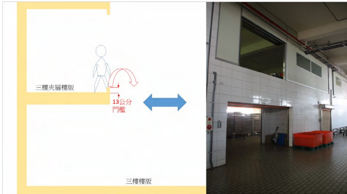
照片 13 樓夾層樓版鐵捲門邊緣處及 3 樓樓版 A-A 剖視(示意圖)。
