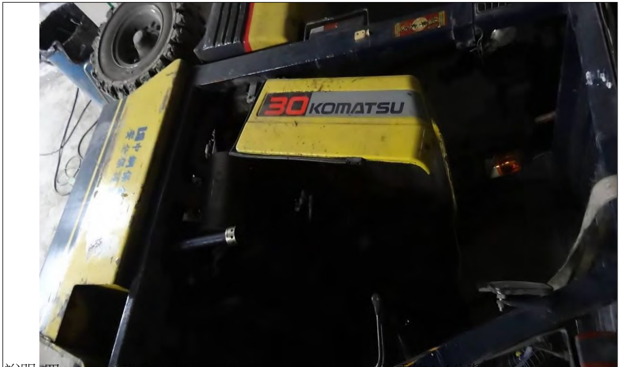
說明 四 荷重3公噸堆高機(廠牌·KOMATSU，淨重約4.4公噸)
