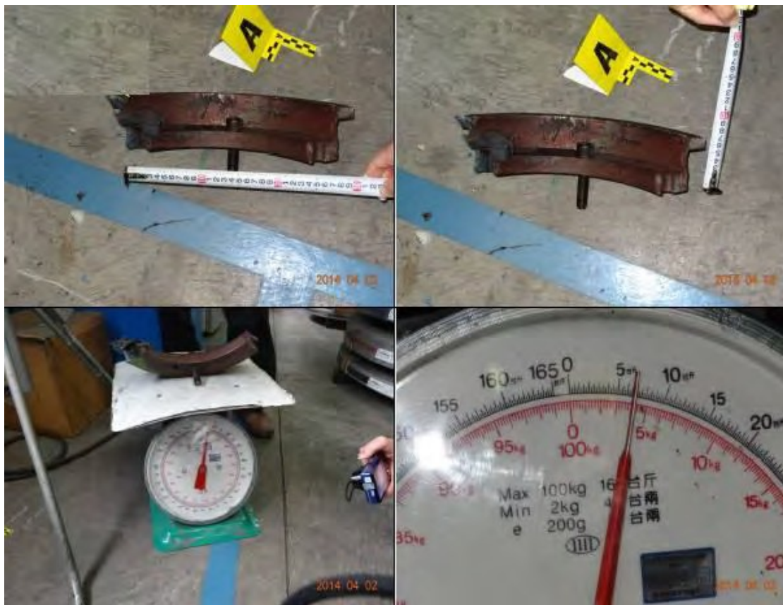
肇災之剎車尾蓋破片(長約30公分、寬約7公分、重約4公斤)。
