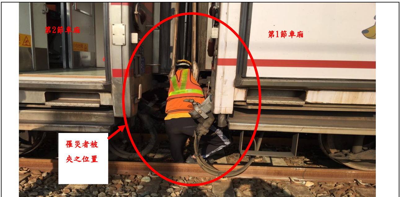
說明 照片：災害現場（罹災者被發現遭夾於 S2 線軌道上之 R124 調車機後方所連結之第 1 與第 2 節車廂之風擋間）。
