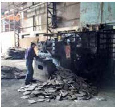
勞工以火法熔煉以取得鉛錠
