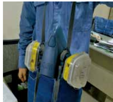
勞工所配戴之呼吸防護具 -N95 等級的綜合氣體濾毒罐
