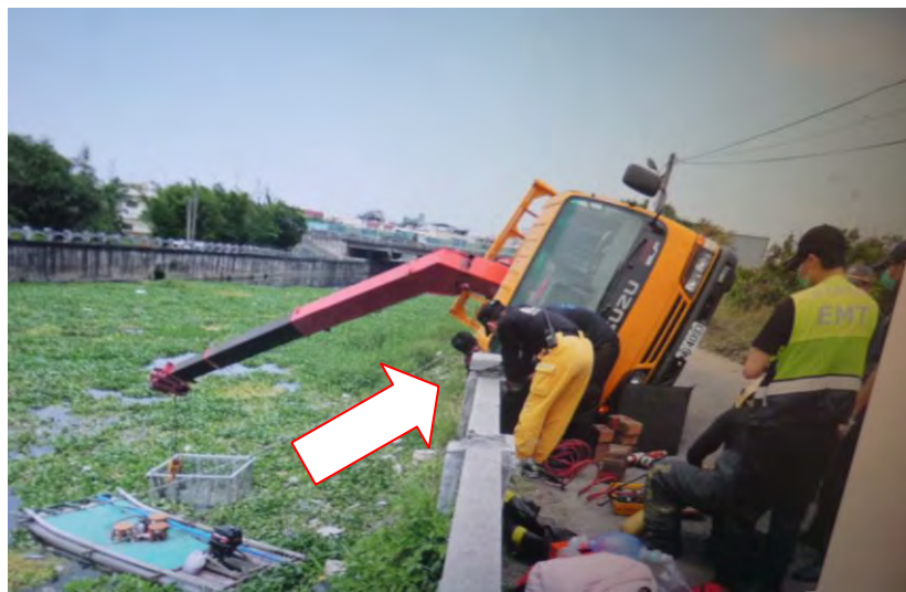
罹災者曾○○遭積載型卡車起重機傾倒壓迫於大排護欄，造成胸部壓迫傷致缺氧性窒息死亡
