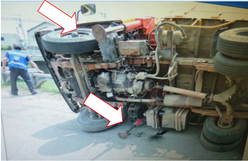
肇災積載型卡車起重機作業未將移動式起重機兩側外伸撐座展開。
