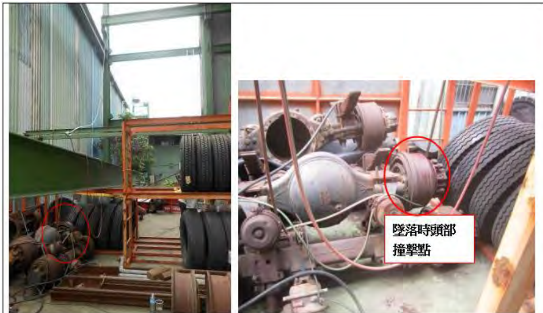
照片說明 3 罹災者墜落後先撞擊放置於地面之貨車煞車鼓。
