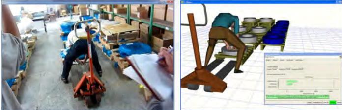
圖一、由 Jack 以 67 公斤以推、拉施力方式模擬分析 L4/L5 受力情形
