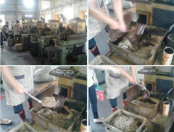
3. 脫油：將適才收集的成品和銅屑鐵屑搬運至脫油機台旁（平均重量 30 公斤，每日至少 100 盤），有手部抓握重物等動作。
