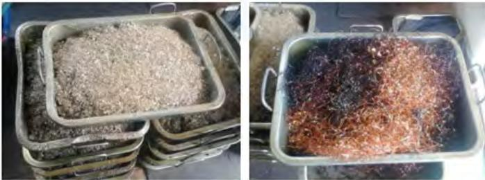
將含切削油的成品和銅屑鐵屑倒入脫油機台的布中，啟動機台脫油，再將成品和銅屑鐵屑倒入脫屑機台中。脫出的油也需倒除。有手部抓握重物甩動（平均重量 30 公斤，每日至少 100 盤）等動作。
