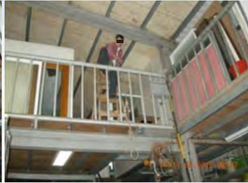
圖八，模擬安裝鐵窗的人力吊掛上拉動作
