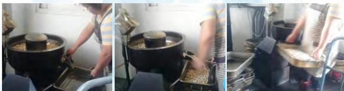
5. 再脫油：將成品倒入脫油機台中。有手部抓握重物動作。
