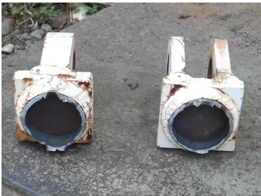
照片 2 格子構造輔助伸臂最前端一節伸臂與第二節伸臂接合處之接頭銷座從焊接熱影響區斷裂外觀
