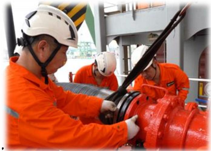
**船舶進出港口期間**，船員需執行繫纜與解纜作業。由於絞纜機屬機械動力設備，操作人員須謹慎操作，並隨時留意拖船動態及纜繩張力狀況，以防因操作不當導致纜繩回彈或斷裂，造成人員受傷。
