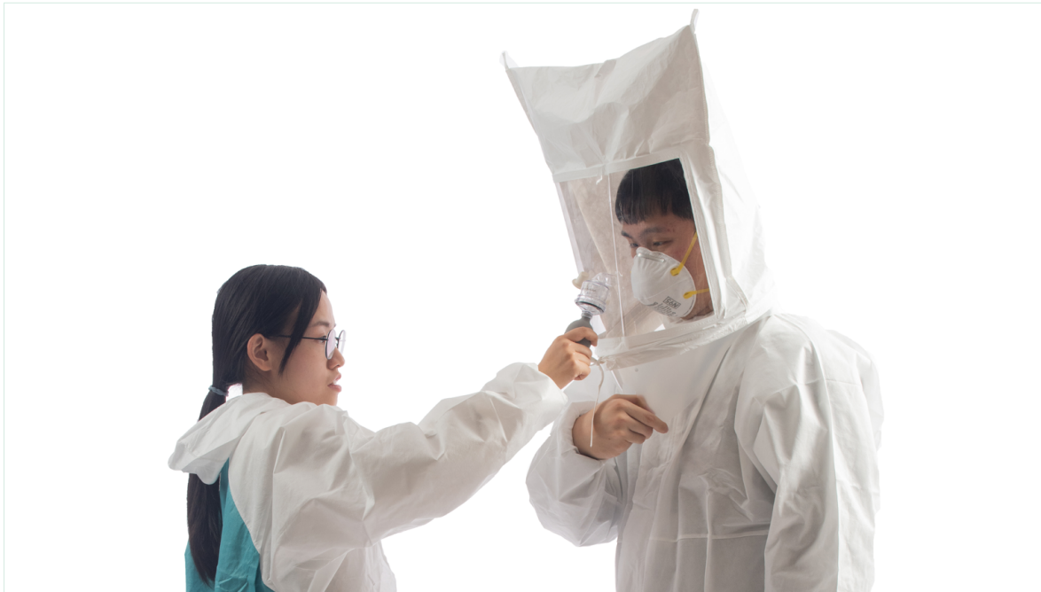
過濾面體式口罩之定性密合度測試
