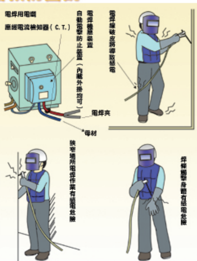
良導體機械設備內狹小空間或於鋼架等高導電性工作場所使用之交流電焊機應有自動電擊防止裝置。
