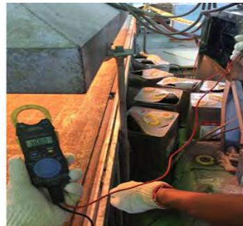
打開鹵素燈電源此時鹵素燈亮，先量測鹵素燈罩電壓約為 36 伏特，之後再量測輸送機台電壓亦為 36 伏特
