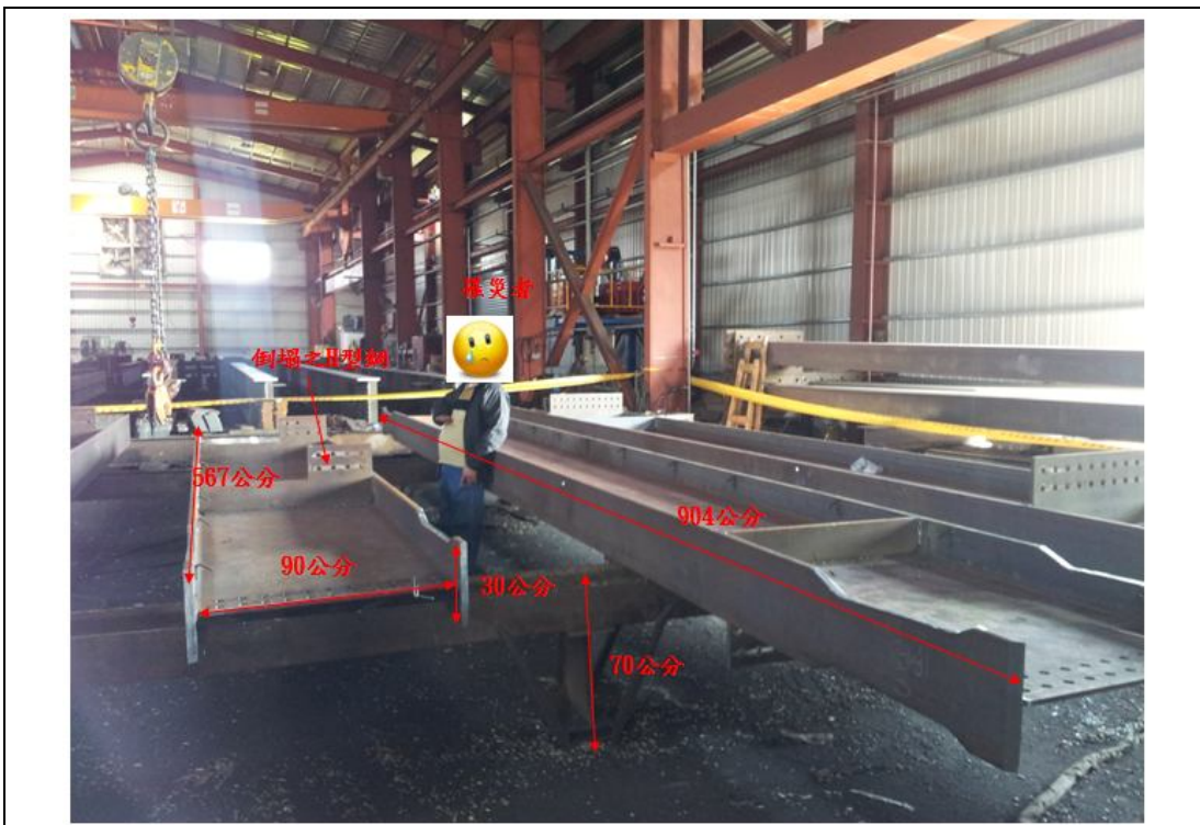
照片一 災害現場為搶救罹災者，故 H 型鋼已被搬動，災害發生時罹災者被夾在兩支 H 型鋼間之情形。
